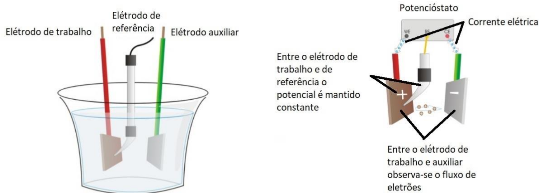
Figura 1.3 – Célula eletroquímica com três eléctrodos (adaptado de [31]).
