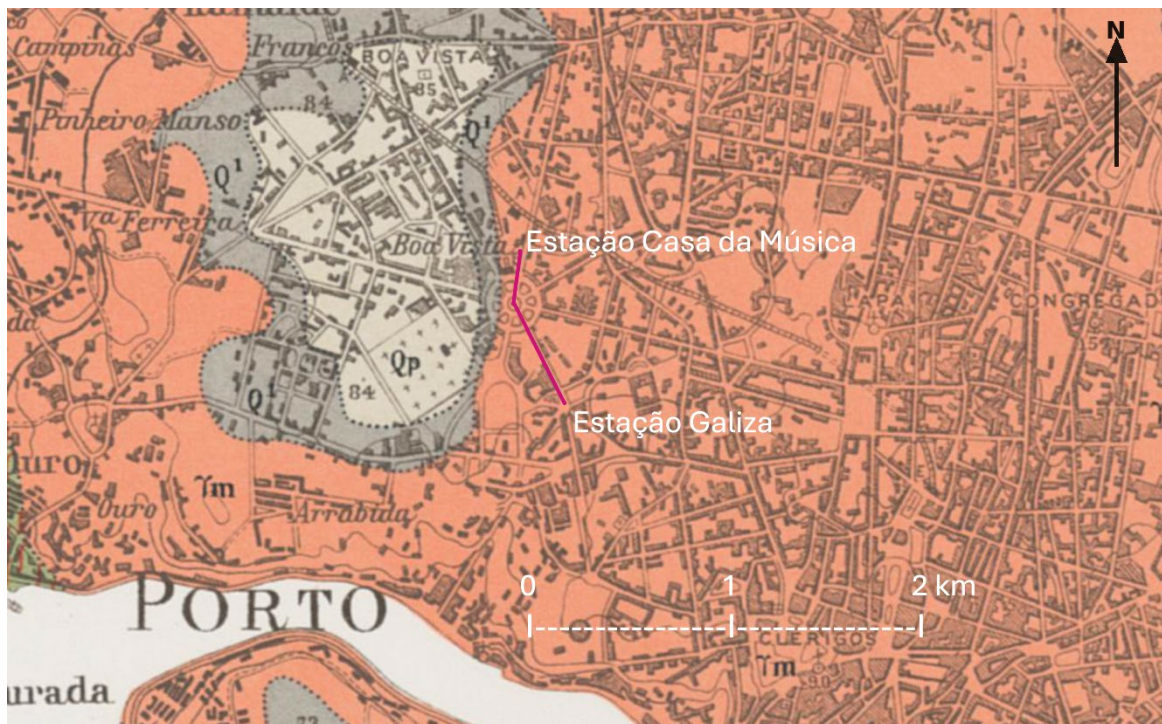
Figura 18 - Enquadramento Geológico do troço Praça da Galiza-Casa da Música com base na Carta Geológica de Portugal (Folha 9-C – Porto: Carrington da Costa & Teixeira, 1957). Ym – Granito alcalino, de grão médio a grosseiro, leucocrata, de duas micas (Granito do Porto); Q1 - Depósitos de praia (80-90 m); Qp – Formação areno-pelítica de cobertura.
