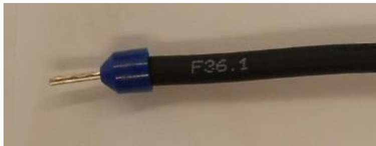
Figura 27 - exemplo de instrução de cabos elétricos
