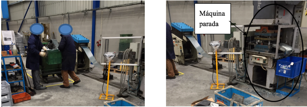
Figura 22 - Processo inicial de retirar a sucata na Pressix
