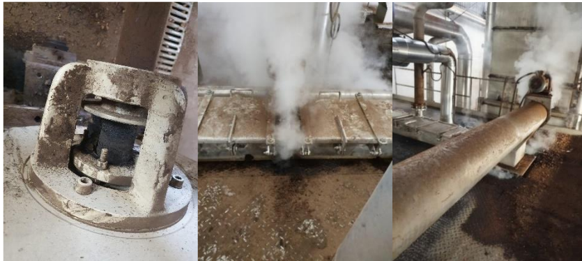
Figura 31- Desgaste de componentes no Popcork
