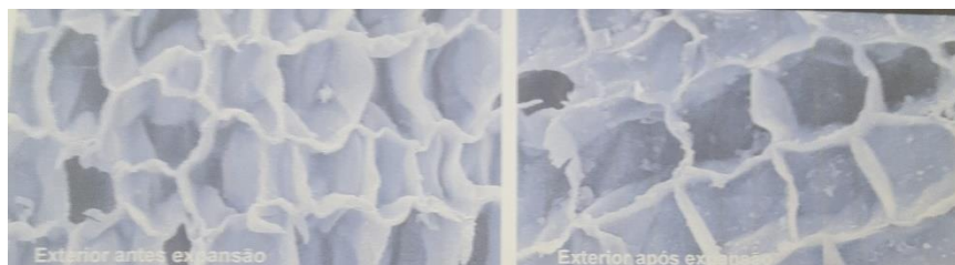
Figura 35- Representação macroscópica da célula da cortiça antes e após expansão
