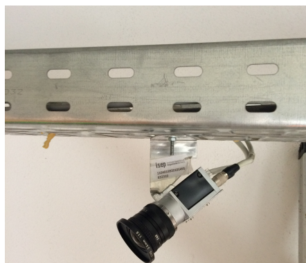
Figura 5.1: Fixação câmaras campo futebol robótico médio.
