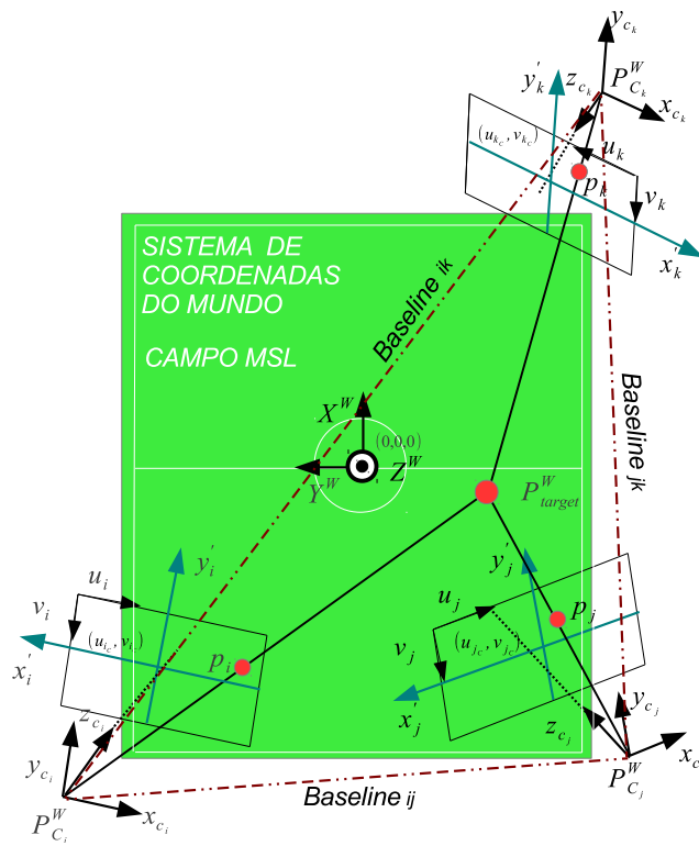
Figura 4.2: Sistema Ground truth Campo MSL.
