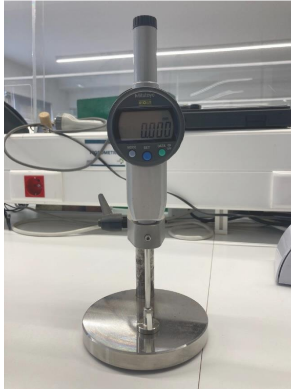
Figura 3.8: Comparador usado para medir o diâmetro inicial e final das rolhas no ensaio.
