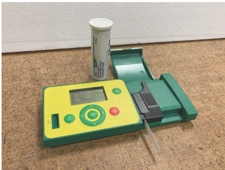
Figura 3.1: Equipamento RQflex utilizado na medição do teor de peróxidos residuais.
