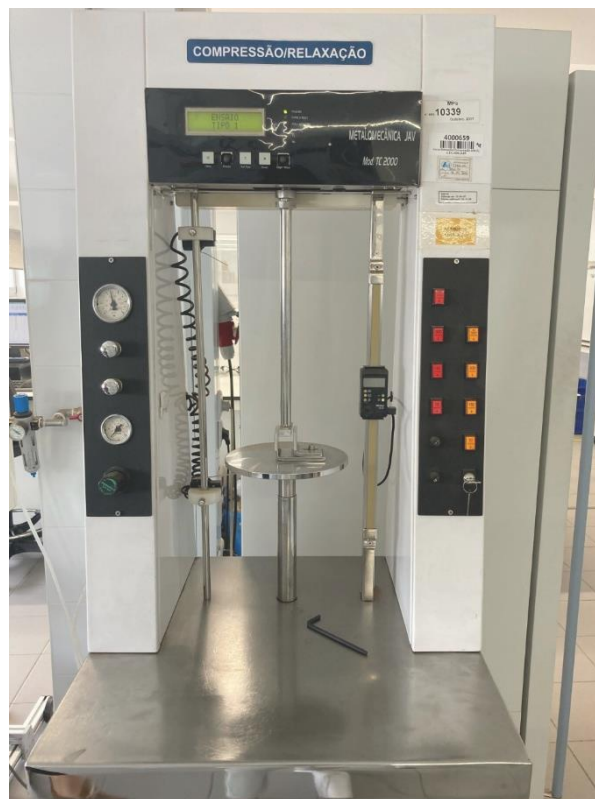
Figura 3.9: Equipamento utilizado para determinar as forças de compressão e de relaxação nas rolhas.
