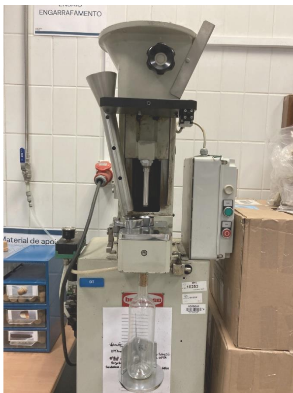
Figura 3.7: Arrolhador utilizado para realizar a taxa de recuperação diametral nas rolhas.
