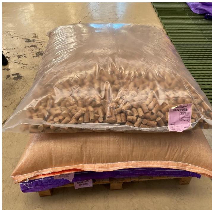
Figura 4.13: Disposição dos 3 tipos de embalagem na paleta. No topo encontra-se a embalagem em plástico; no meio encontra-se a embalagem de rafia e plástico e no fundo está a embalagem de rafia.
