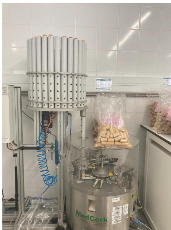
Figura 3.3: MedCork utilizado para avaliação dimensional das rolhas.
