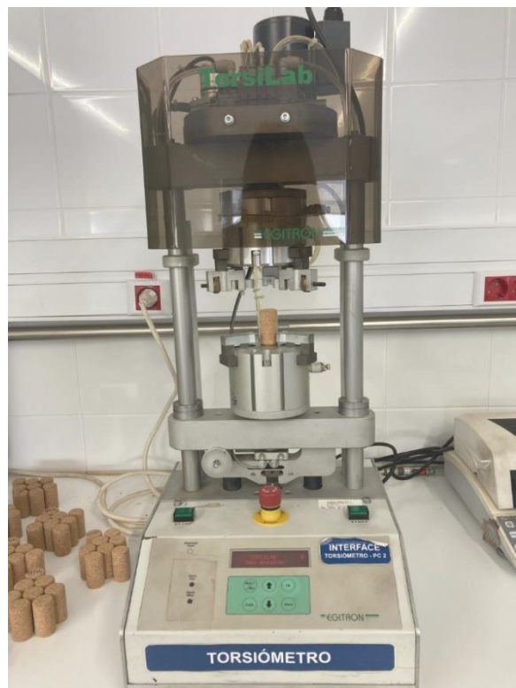
Figura 3.5: Torsiómetro utilizado para realizar o ensaio de torção.
