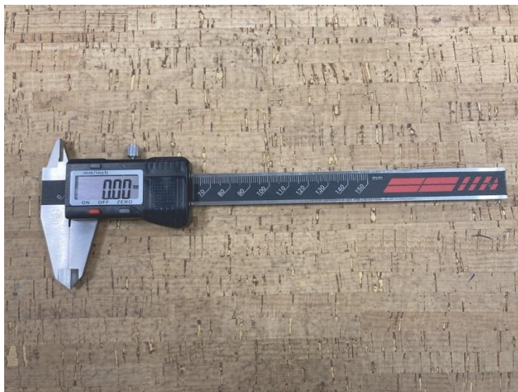
Figura 3.10: Paquímetro utilizado para medir a migração de vinho nas rolhas.
