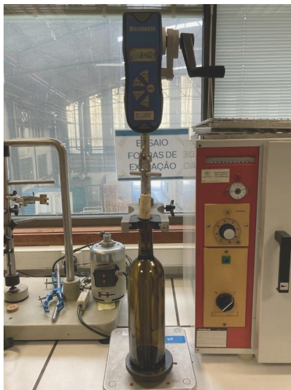
Figura 3.6: Dinamómetro utilizado para medir as forças de extração.
