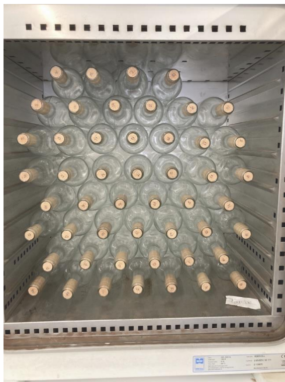
Figura 4.3: Rolhas 51 a 100 em garrafa, na estufa a 60 °C.
