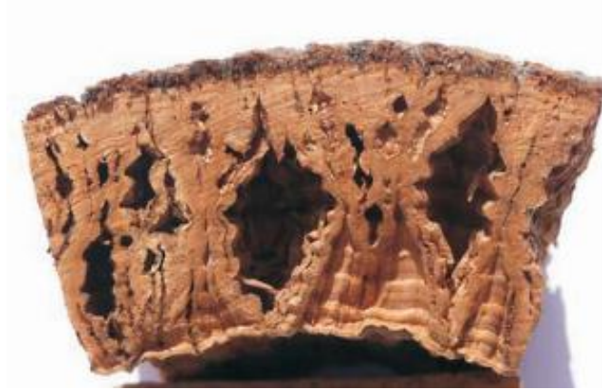
Figura 2.12: Ilustração de cortiça com bofe.
