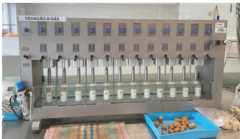
Figura 3.12: Aquário utilizado para verificar a impermeabilidade das rolhas.
