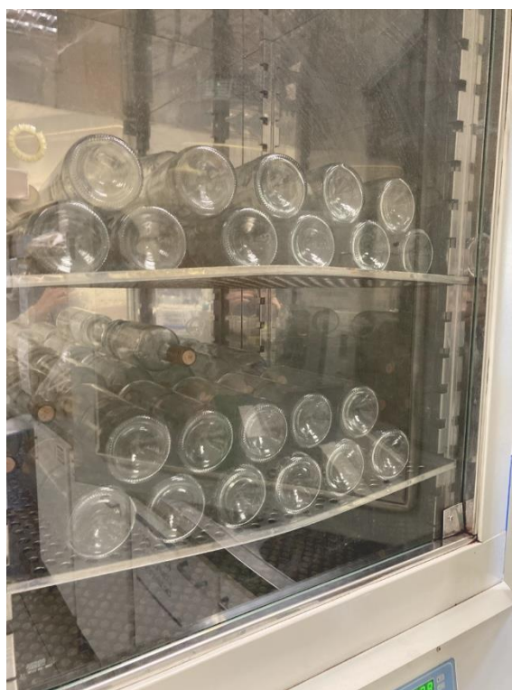
Figura 4.2: Rolhas 1 a 50 em garrafa, na estufa a 40 °C.
