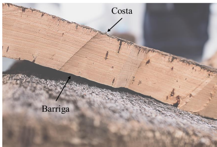
Figura 2.3: Representação das costa e barriga que compõem a cortiça (adaptado de [5]).
