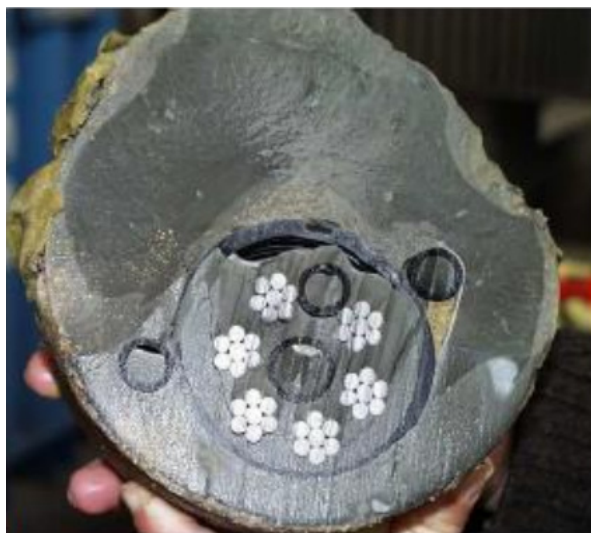
Figura 22 – Secção transversal de uma ancoragem (Thiago Porto, 2015)
