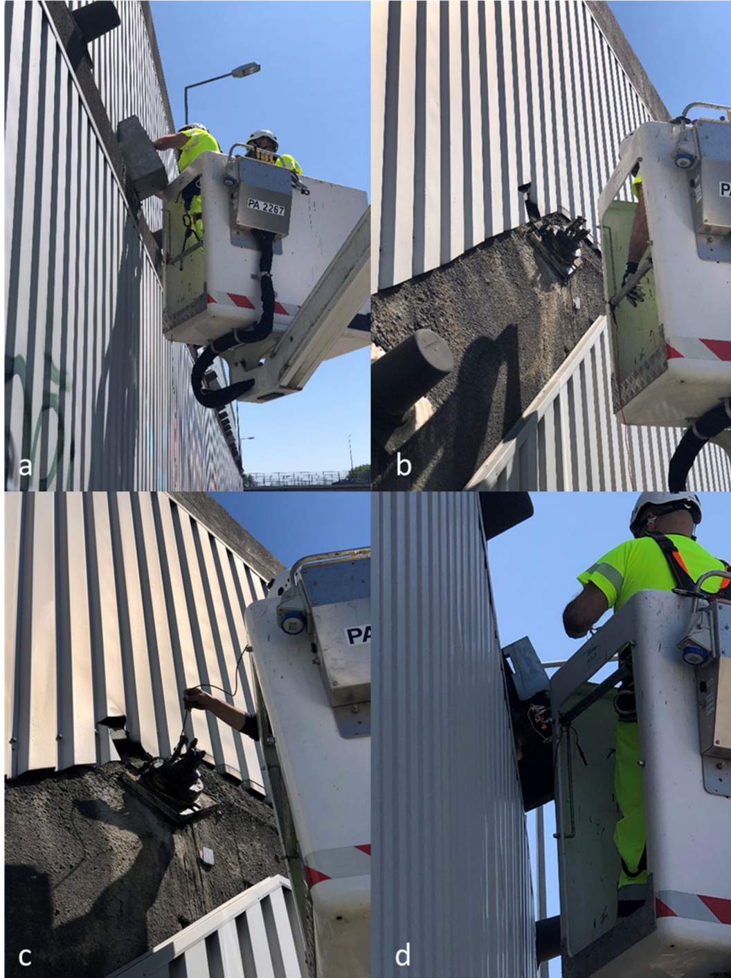
Figura 37 - a) Trabalhos de montagem e desmontagem da caixa metálica; b) Inspeção visual; c) Endoscopia; d) Ensaio de resistência elétrica
