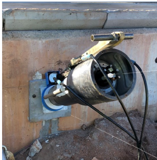
Figura 16 - Exemplo representativo do ensaio Lift-Off em cordões
