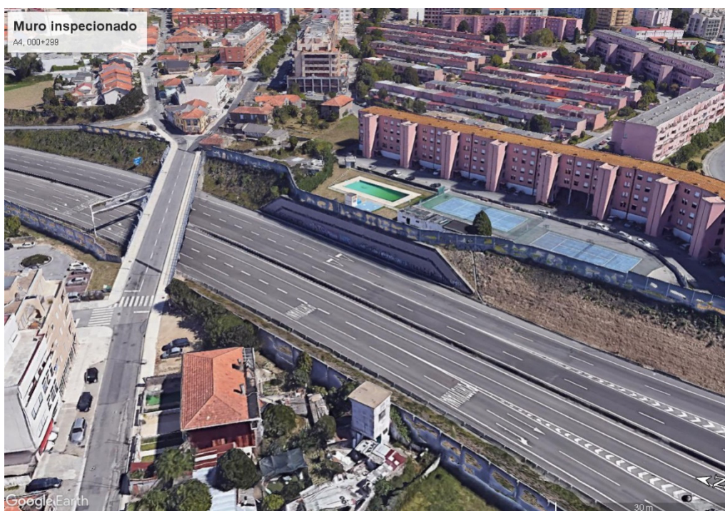
Figura 30 – Muro ancorado sito na Concessão do Grande Porto ao Pk 000+299 (Software Google Earth)
