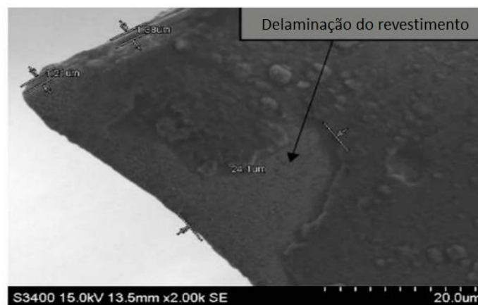
Figura 11 – Detalhe do mecanismo de desgaste, delaminação do revestimento, numa fresa [103]
