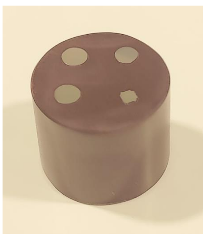
Figura 13 – Montagem da secção transversal de uma ferramenta revestida, juntamente com as secções não revestidas, sendo que estas visavam apenas induzir o necessário equilíbrio na amostra
