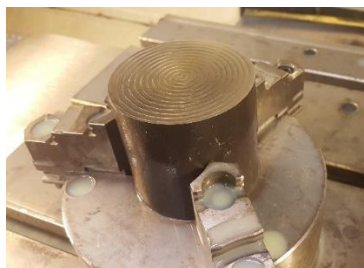
Figura 14 – Montagem da peça a maquinar na bucha autocentrante, Bison 3575
