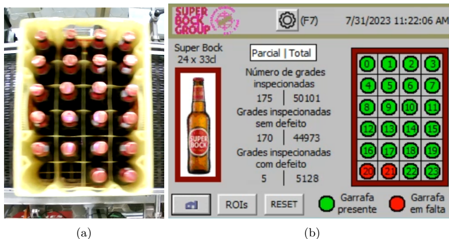
Figura 5.5: Grade Super Bock com duas garrafas em falta (lado a lado).
