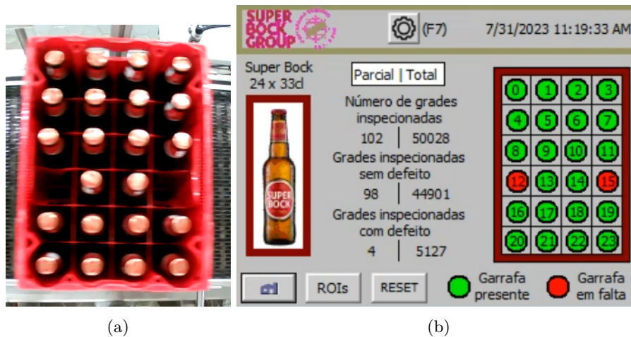
Figura 5.4: Grade Super Bock com duas garrafas em falta (lados opostos).
