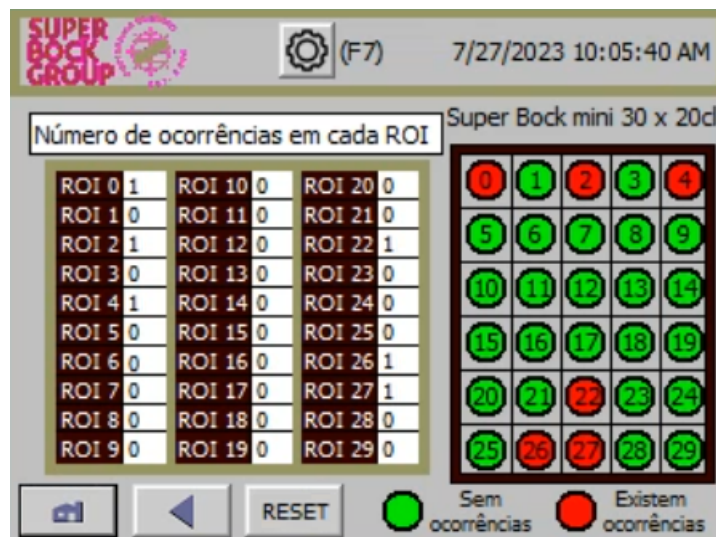
Figura 5.11: Contabilização de ocorrências na Grade Super Bock mini.
