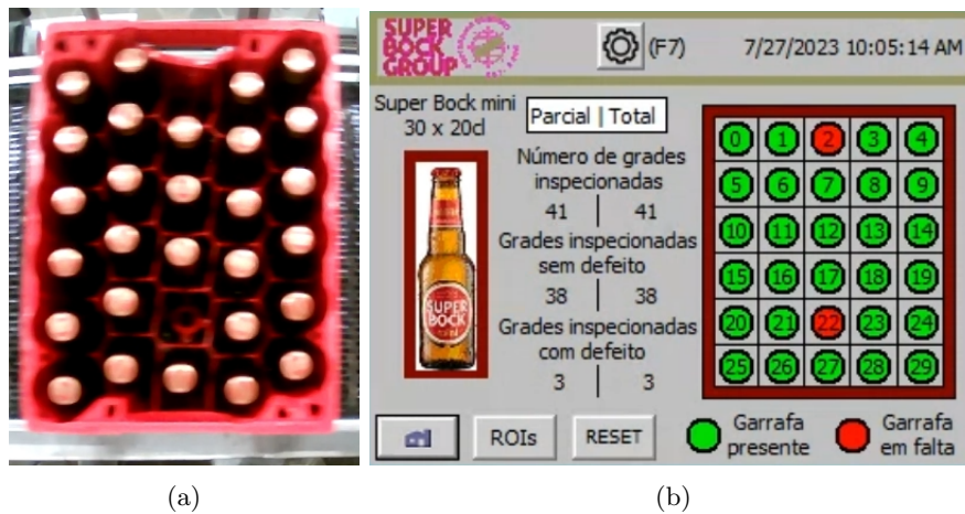
Figura 5.10: Grade Super Bock mini com duas garrafas em falta (aleatório).
