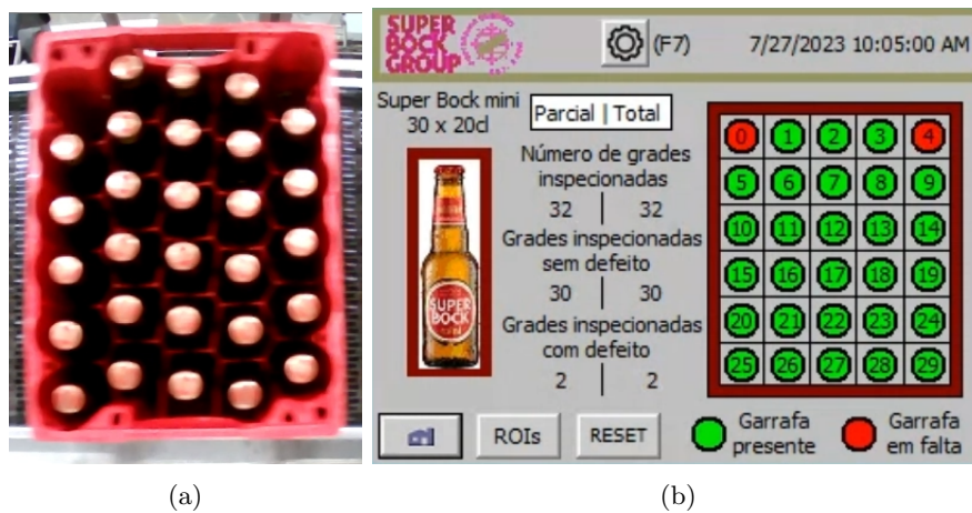
Figura 5.9: Grade Super Bock mini com duas garrafas em falta (lados opostos).
