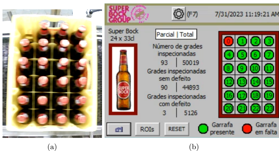
Figura 5.3: Grade Super Bock com uma garrafa em falta.
