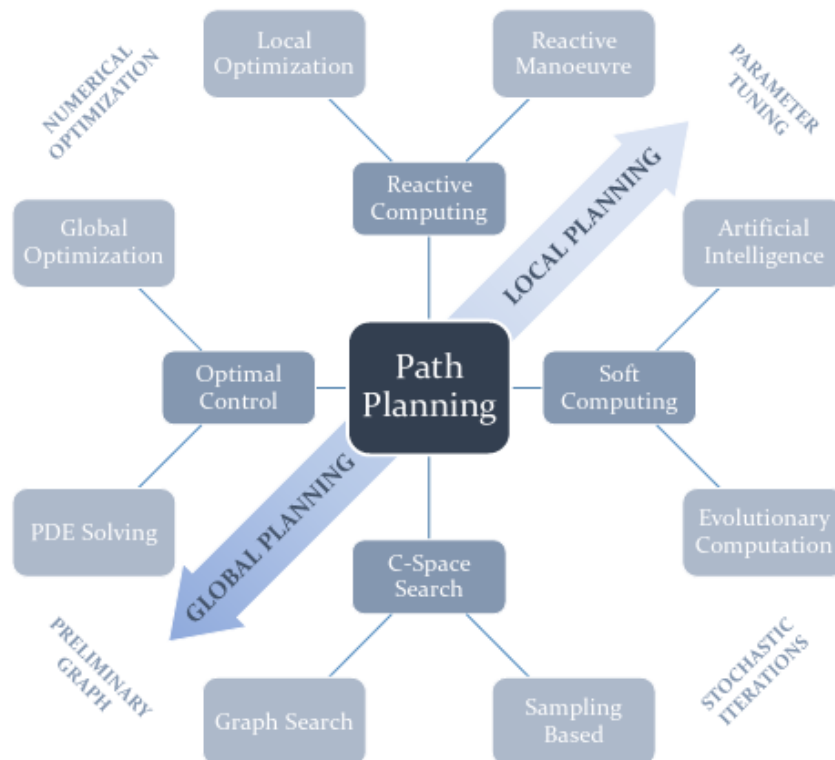
Figura 3.8: Esquema que exemplifica as diferentes arquiteturas de planeamento, bem como como se relacionam entre elas. [13]
