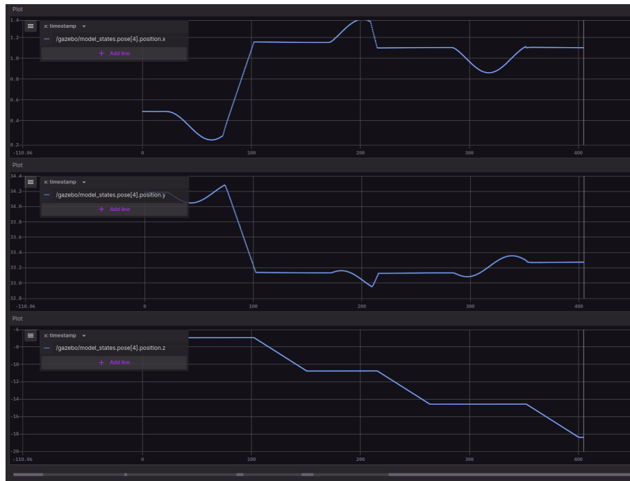
Figura 8.5: Gráfico 2D que demonstra ao longo do tempo, a posição do robô nas três componentes X, Y, Z .
