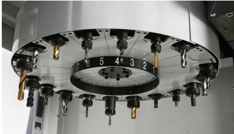
Figura 3 - Carrossel de ferramentas de uma máquina CNC
