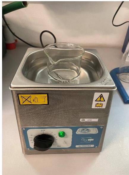
Figura 51 – Limpeza de ferramenta de corte em banho de ultrassons
