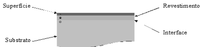
Figura 20 – Aplicação de revestimento no material de base/substrato (adaptado de [44])
