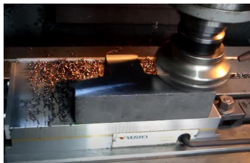
Figura 17 – Fixação de peça em base magnética (adaptado de [36])
