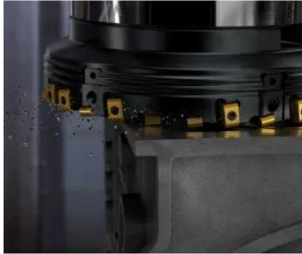
Figura 11 – Fresa providas de insertos (adaptado de [21])
