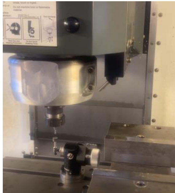
Figura 49 – Sistema de medição de ferramenta OTS da Renishaw
