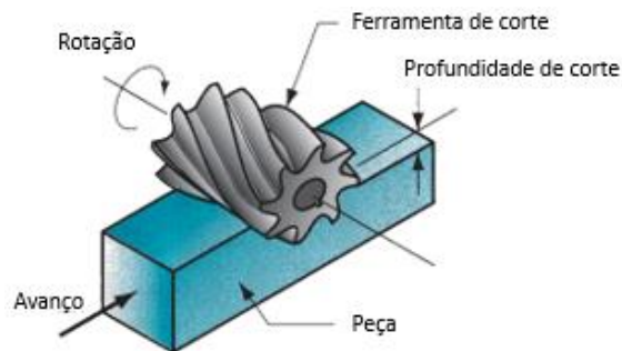
Figura 3 – Fresagem periférica: Diagrama esquemático legendado (adaptado de [5])
