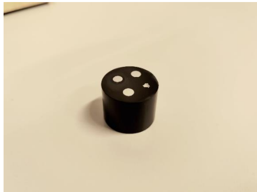
Figura 54 – Amostra embebida em resina termoendurecível, pronta para ser analisada
