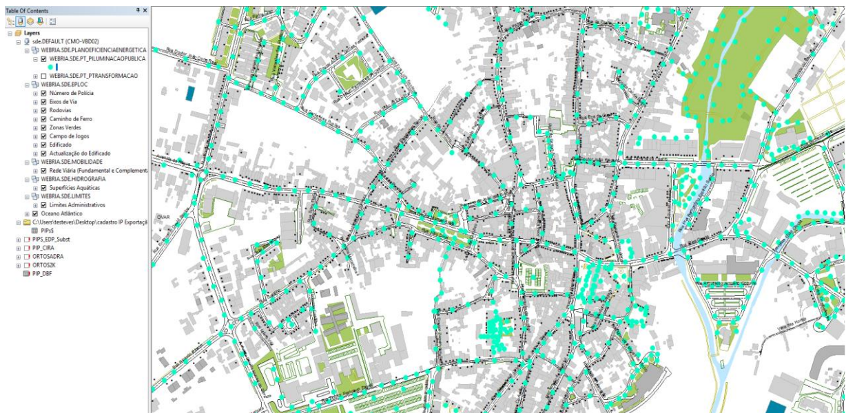
Figura 29 Exemplo de Luminárias IP na freguesia de Ovar (Plataforma SIG ArcGIS®).
