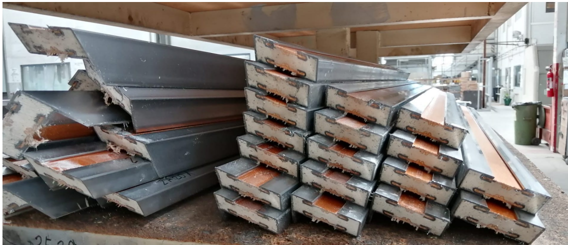
Figura 3.3 - Perfil de aço já cortado
