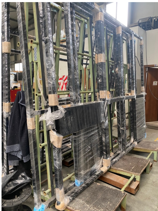
a) Armazenamento dos caixilhos
