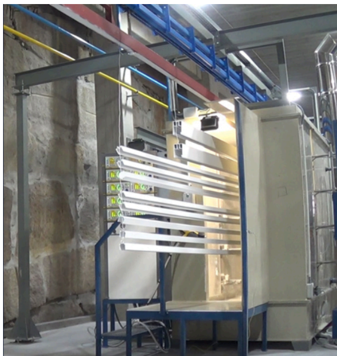
Figura 3.21 - Introdução dos perfis no forno (Valportas, 2021)
