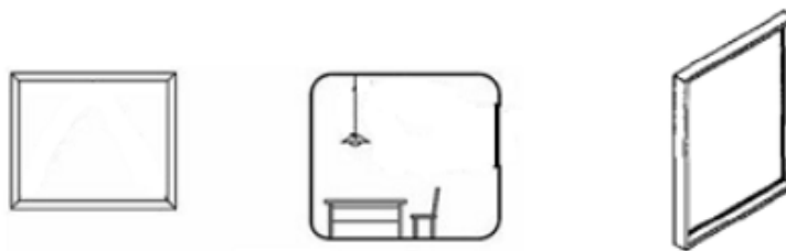
Figura 2.2 - Janela fixa (desenho, forma de ventilação e perspetiva (Santos, 2012)
