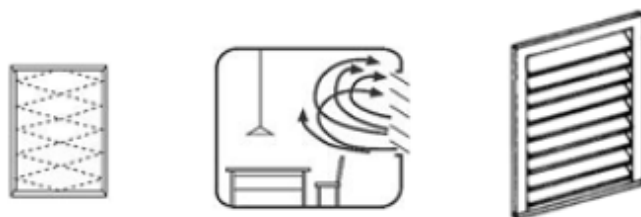
Figura 2.10 - Janela de vitrô (desenho, forma de ventilação e perspetiva) (Santos, 2012)
