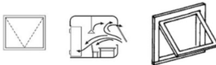
Figura 2.5 - Janela projetante, eixo superior (desenho, forma de ventilação e perspectiva) (Resende, 2020)
