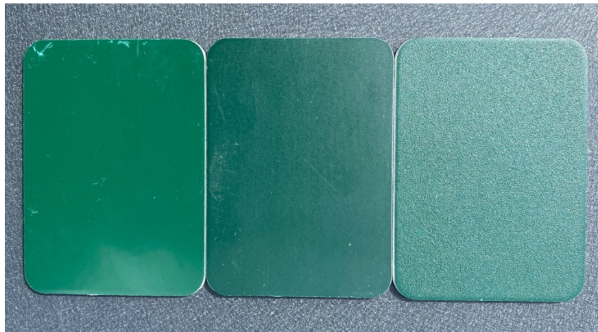
Figura 2.22 - Acabamento do alumínio (brilhante, mate e texturado na cor verde)
