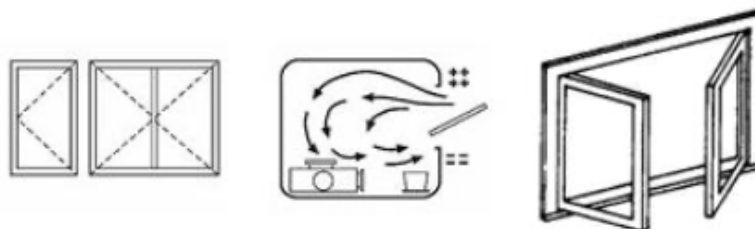
Figura 2.3 - Janela de batente (desenho, forma de ventilação e perspetiva (Santos, 2012)
