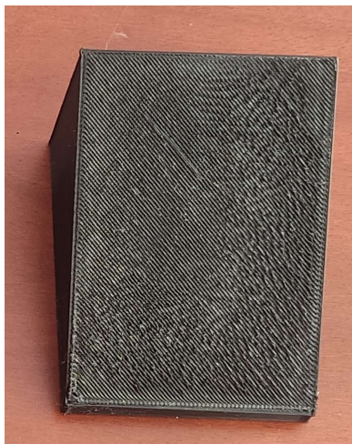
Figura 88 - Provete "Inclinação" com 30° de inclinação e 0,3 mm de largura de extrusão.
