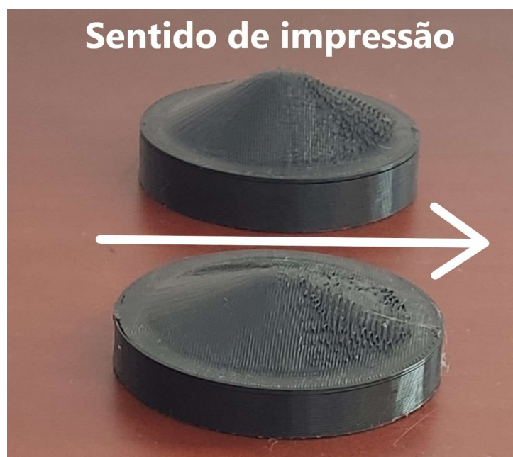
Figura 92 - Sentido de impressão durante a impressão da camada sólida superior.
