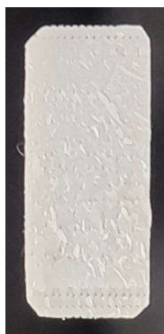
Figura 121 - Interior do provete Z planar.
