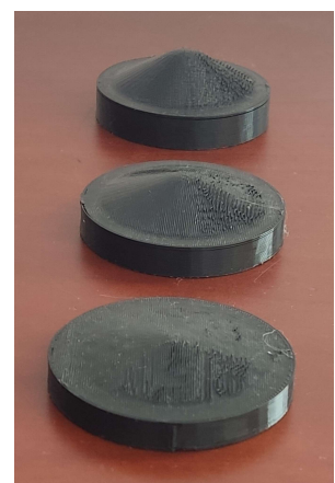
Figura 165 - Vista em perspectiva dos provetes "Parábola" não planares, com 0,3 mm de largura de extrusão.
