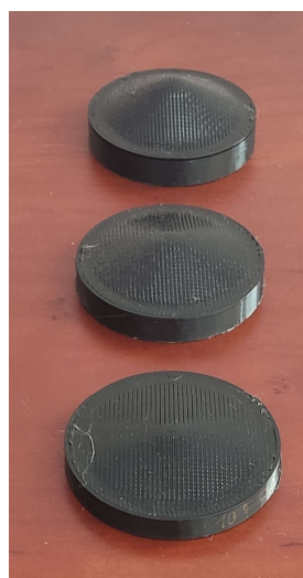
Figura 171 - Vista em perspectiva dos provetes "Parábola" não planares, com 0,6 mm de largura de extrusão.
