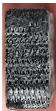
Figura 123 - Interior do provete Z 20° não planar.
