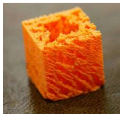
Figura 25 - Efeito de falta de extrusão [72].
