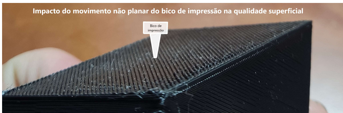
Figura 130 - Degraus observados em alguns provetes "Inclinação" não planares.
