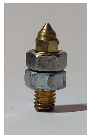
Figura 38 - Aplicação de fêmeas roscadas no bico de extrusão Vulcano.
