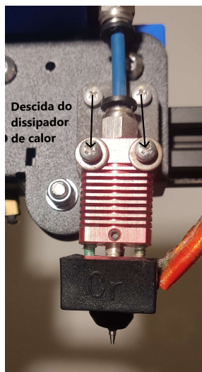
Figura 45 - Reposicionamento do dissipador de calor.
