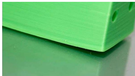
Figura 19 - Representação efeito de warping [72].
