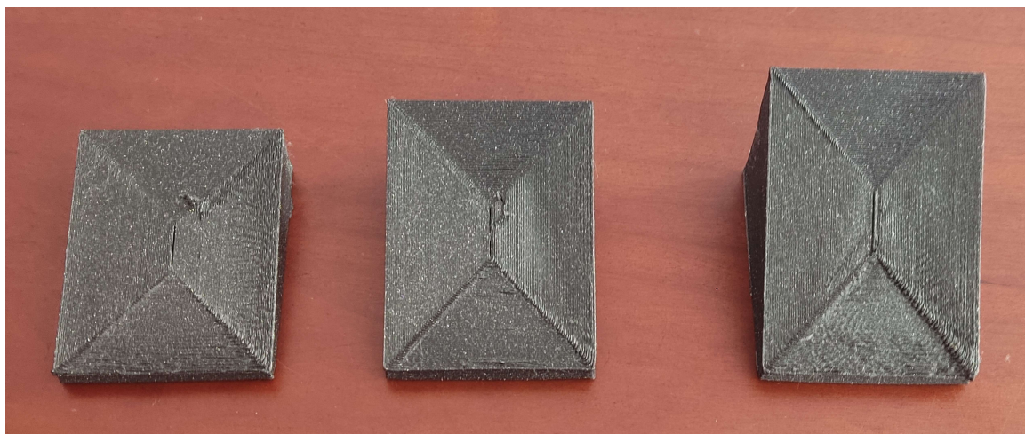
Figura 90 - Provetes "Inclinação" impressos com padrão concêntrico.
