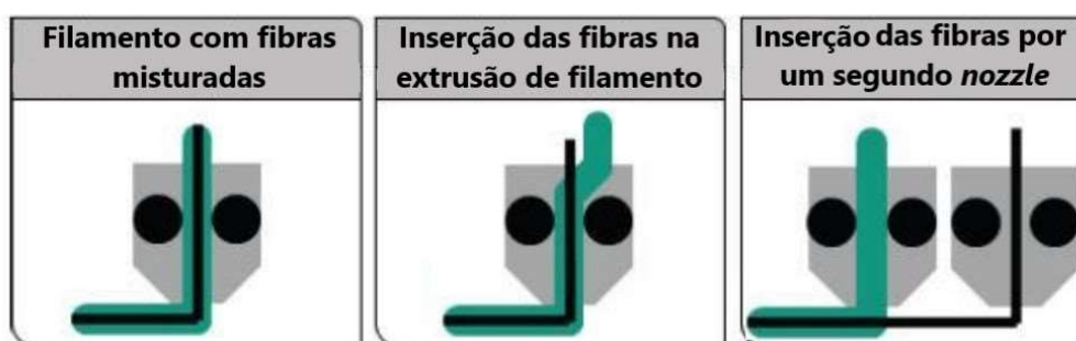
Figura 26 - Formas de colocar fibras numa impressão FDM [77].
