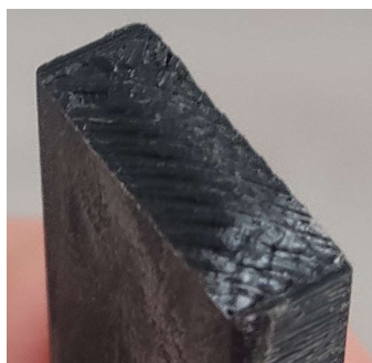
Figura 118 - Rotura de um provete Z não planar por separação de camadas.
