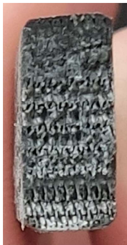
Figura 116 - Rotura de um provete XY não planar, em zona de transição entre impressão planar e não planar.
