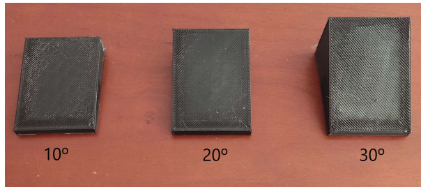
Figura 154 - Vista de topo dos provetes "Inclinação" com 0,5 mm de largura de extrusão.
