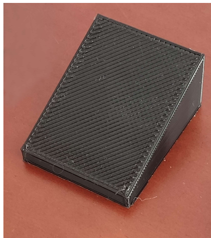
Figura 89 - Provete "Inclinação" com 20° de inclinação e 0,7 mm de largura de extrusão.
