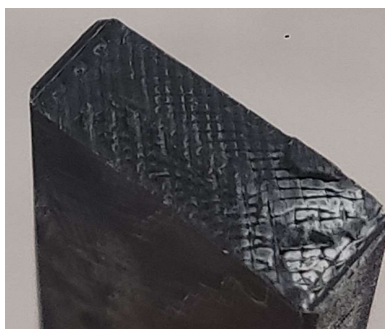
Figura 119 - Rotura de um provete Z não planar por separação de camadas com ligeira quebra da própria camada.
