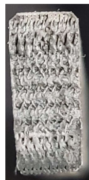
Figura 124 - Interior do provete Z 30° não planar.
