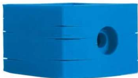
Figura 20 - Representação do efeito delaminação [73].
