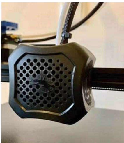
Figura 32 - Cabeça de impressão da Ender 3 V2 .
