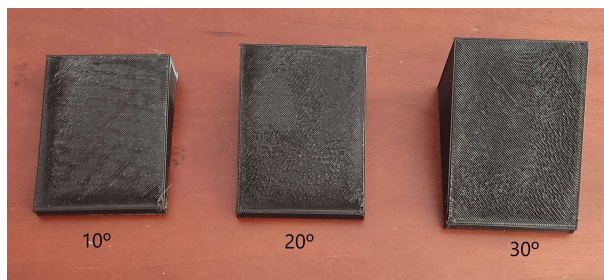
Figura 150 - Vista de topo dos provetes "Inclinação" com 0,3 mm de largura de extrusão.
