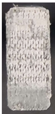
Figura 122 - Interior do provete Z 10° não planar.
