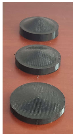
Figura 167 - Vista em perspectiva dos provetes "Parábola" não planares, com 0,4 mm de largura de extrusão.
