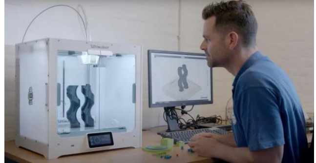
Figura 4 - Utilização de software no processo de impressão 3D Fonte: All3DP (2024).
