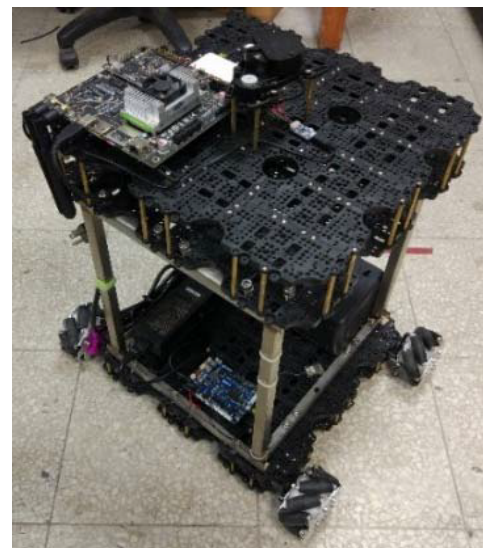
(b) Protótipo baseado Turtlebot 3 Waffle Pi robot
