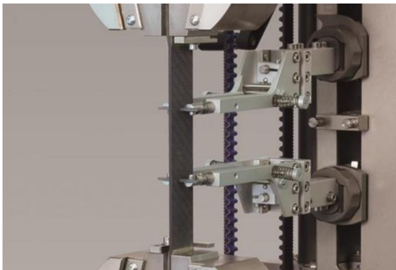
Figura 11- Configuração do ensaio de tração a materiais compósitos [44]
