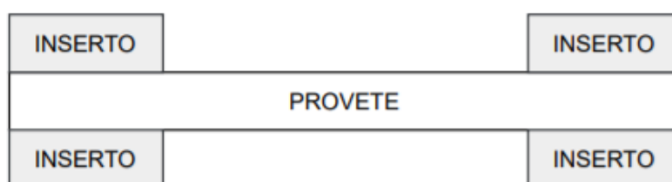
Figura 10- Provette para ensaio de tração com insertos colados
