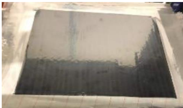
Figura 30- Colocação dos laminados no equipamento de fabrico
