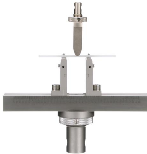
Figura 12- Configuração do ensaio F3P [47]
