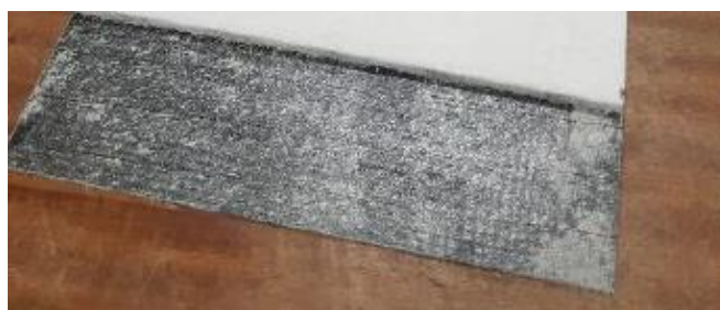
Figura 31- Superfície rugosa obtida devido à utilização da camada de peel ply
