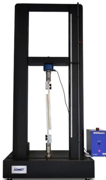
Figura 17- Configuração do ensaio de corte do núcleo [65]
