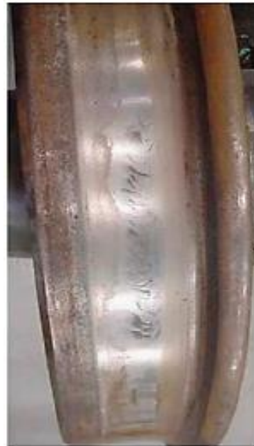
Figura 2.21 – Poligonização na roda (Liao, 2020).
