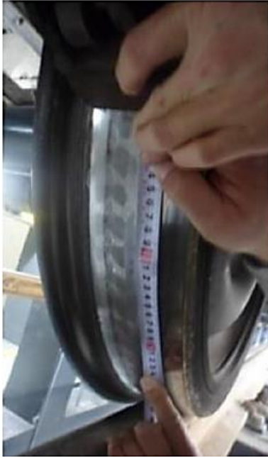
Figura 2.20 – Ondulação na roda com um comprimento de onda aproximadamente igual a 30 mm (Tao et al., 2020).
