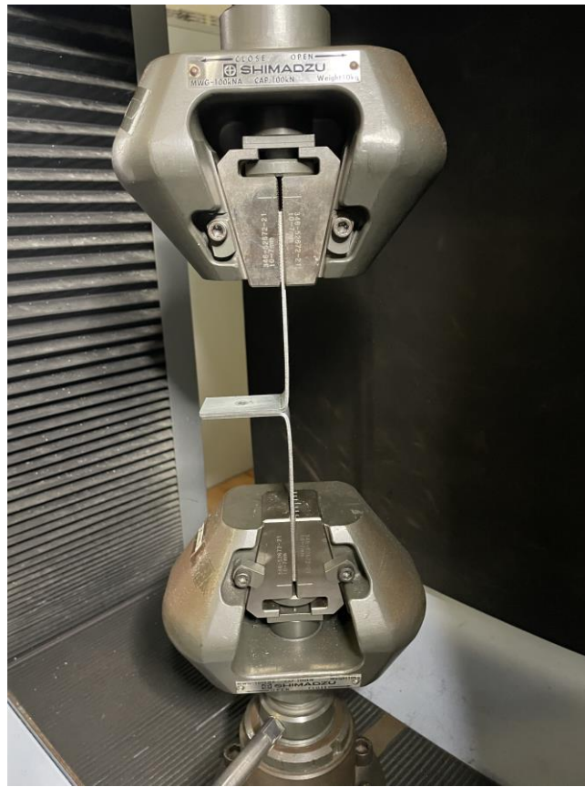
Figura 32 - Ensaio de arrancamento
