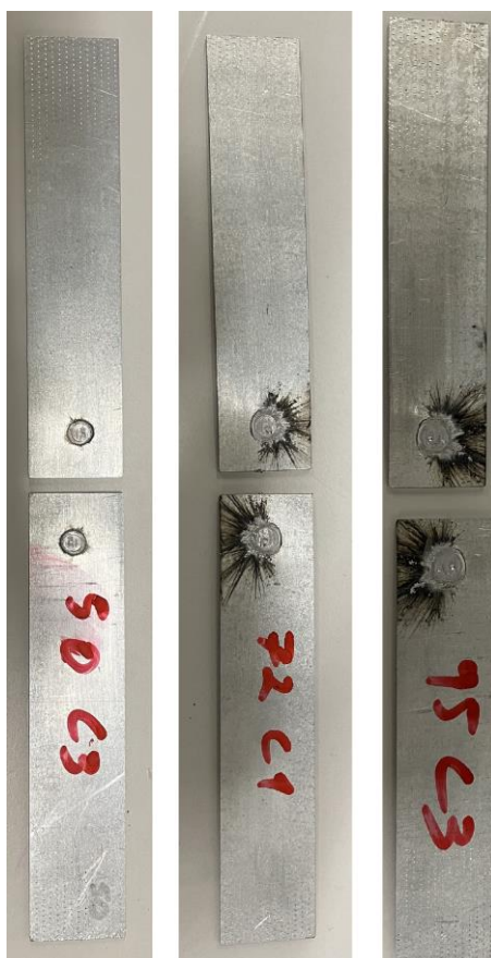
Figura 47 – Exemplo de provetes usados nos testes de corte para as várias intensidades de corrente: 50A, 72A, 95A.
