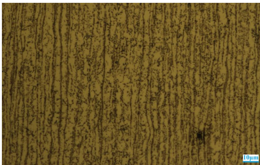
Figura 46 - Provete TIG 110A - Micro material base (Ampliação 200x)
