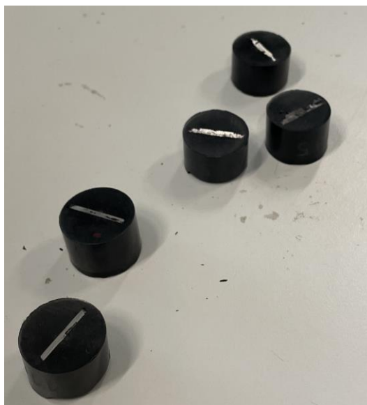
Figura 26 - Amostras macrografia, micrografia e durezas
