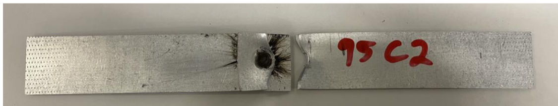
Figura 48 - Rotura de provete pela chapa
