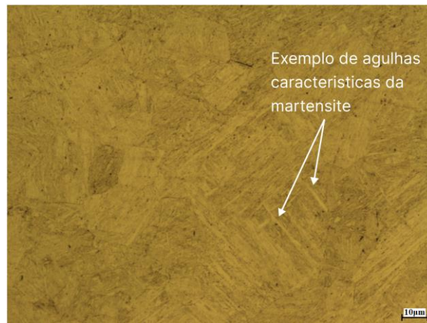
Figura 43 - Presença de Martensite na zona termicamente afetada (retirada do provete TIG 125A – Ampliação 200x)
