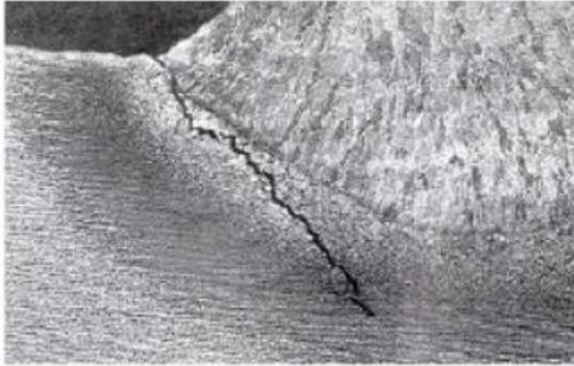
Figura 19 - Fissuração a frio
