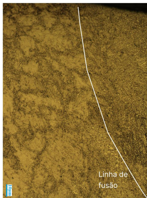
Figura 44 - Provete TIG 125A - Micro cordão de soldadura (Ampliação 100x)
