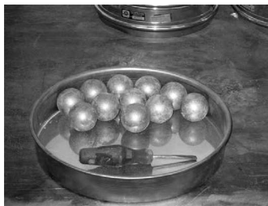
Figura 32 - Esferas de aço - carga abrasiva (Francisco Pereira Marinho & Irmão, S.A; Fontelo).
