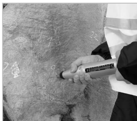
Figura 34 - Exemplo de ensaio com martelo de Schmidt .
