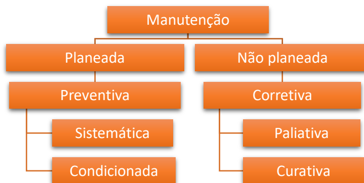
Figura 5 - Manutenção segundo Brito
