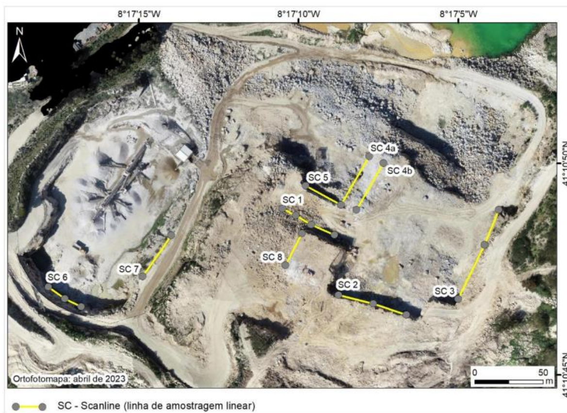
Figura 40- Ortofotomapa de pormenor para desenvolvimento de um esboço cartográfico de zonamento geotécnico com a localização das diferentes ‘scanlines’ aplicadas para o levantamento dos parâmetros geológico-geotécnicos, captada em abril de 2023 (adaptado de Guedes, 2024).
