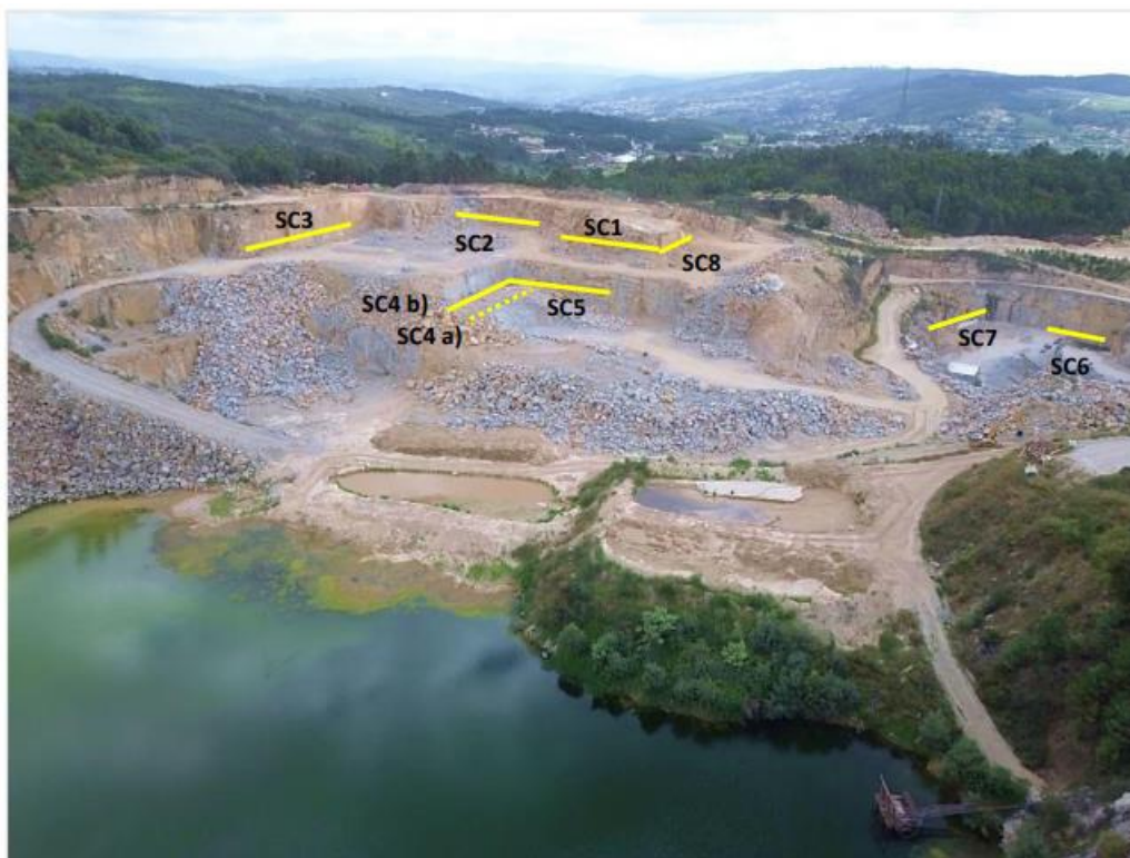
Figura 41- Fotografia aérea da pedreira do Facho com referência às bancadas cartografadas pela Técnica da Amostragem Linear (TAL) / ‘scanlines’, captada em junho de 2023 (adaptado de Guedes, 2024).
