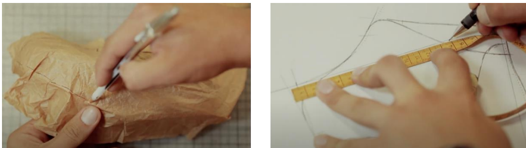
Figura 8 - Do lado esquerdo uma técnica para retirar a volumetria da forma que depois é transposta para o plano que é criado, como se observa no lado direito.
