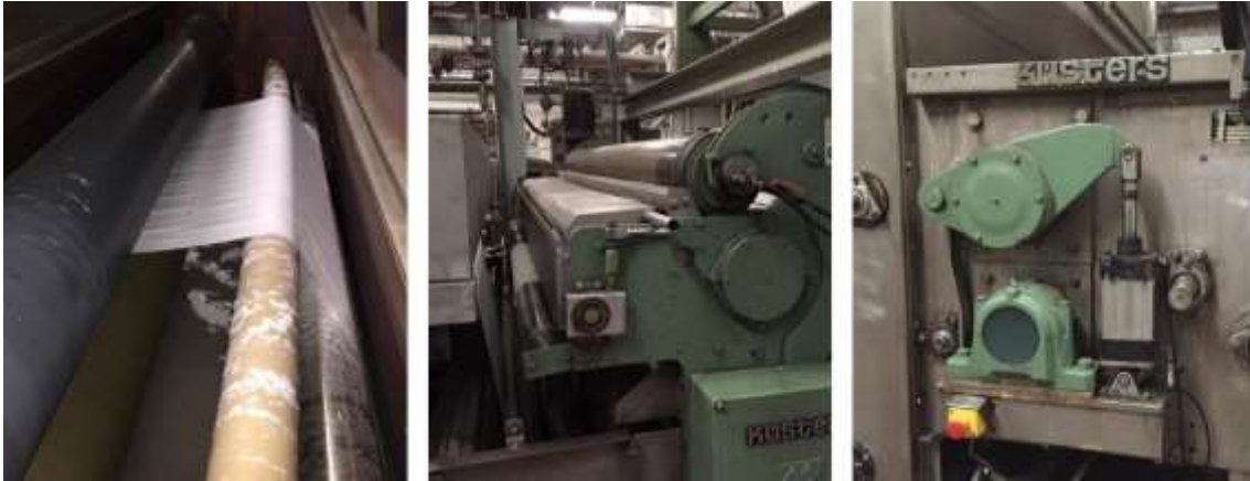
Figura 9 – Rolos de um foulard (à esquerda), foulard com sistema de aperto pneumático (ao centro) e foulard com sistema de aperto hidráulico (à direita)
