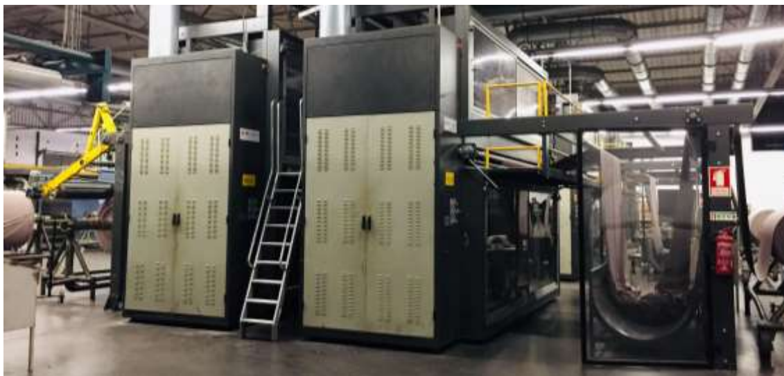
Figura 11 – Carda 7, composta por dois conjuntos de cardas com dois tambores na vertical por conjunto
