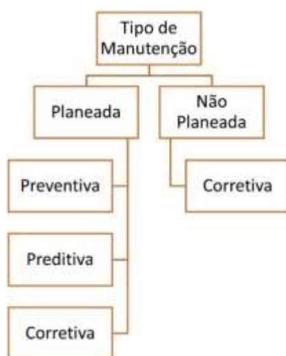
Figura 2 – Tipos de Manutenção, adaptado de Gulati (2012)
