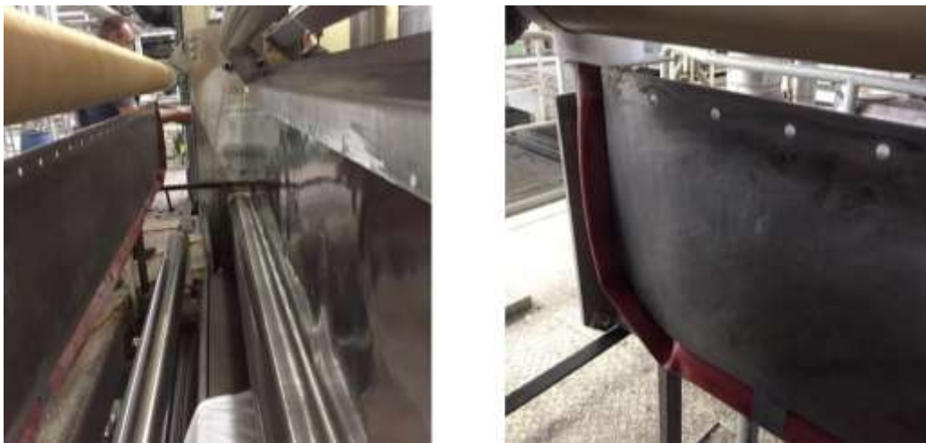
Figura 10 – Chapas de vedação do FlexNip (à esquerda) e sistema de borrachas que pressionam as chapas (à direita)
