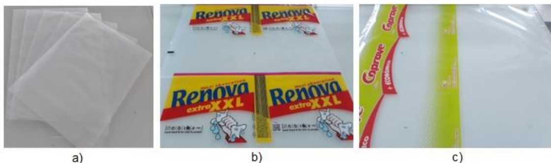
Figura 1. 1 - Exemplos de filmes produzidos na Vizelpas: a) PEHD extrudido, b) PEHD impresso e c) laminado PET/PEHD.
