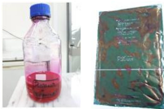
Figura 6. 16 - Frasco com a solução de propanol com rodamina B e filme coberto com essa solução.
