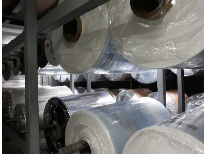
Figura 4. 7 - Estufa onde se encontram as bobines a estabilizar na Vizelpas.
