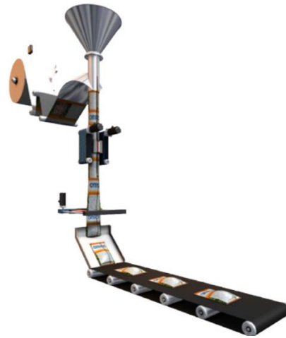
Figura 2. 8 - Exemplo de uma máquina de enchimento e selagem vertical para embalagem de produtos em sacos [16].
