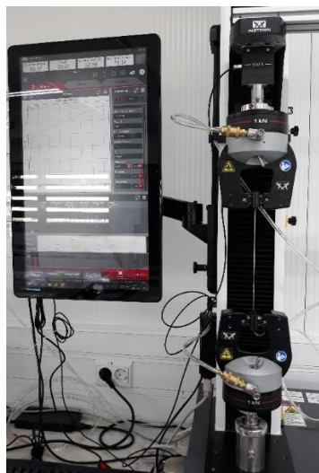
Figura 6. 5 - Equipamento Universal de Ensaio para determinar as propriedades de tração.
