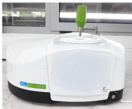
Figura 6. 1 - FTIR acoplado com ATR.
