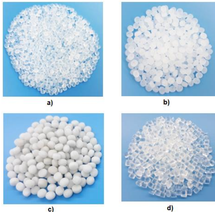
Figura 3. 2 - Exemplos de matérias-primas para extrusão (grão) testadas por FTIR-ATR: a) PA, b) PEBD, c) EVA (Etileno Acetato de Vinilo) e d) EVOH.
