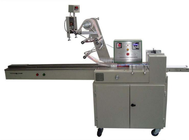
Figura 2. 10 - Exemplo de uma embaladora flow pack .
