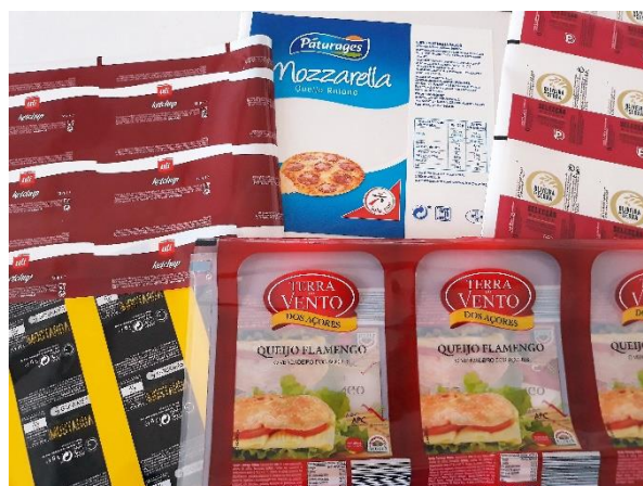
Figura 2.7 - Exemplos de filmes barreira PET laminado com PEBD Copolímero de etileno e álcool vinílico (EVOH) PEBD.
