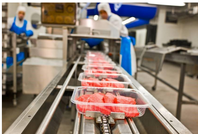
Figura 2. 11 - Exemplo de uma linha de produção de embalamento lidding [15].
