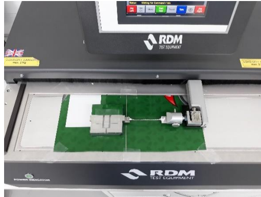
Figura 6. 19 - Teste da determinação do COF.
