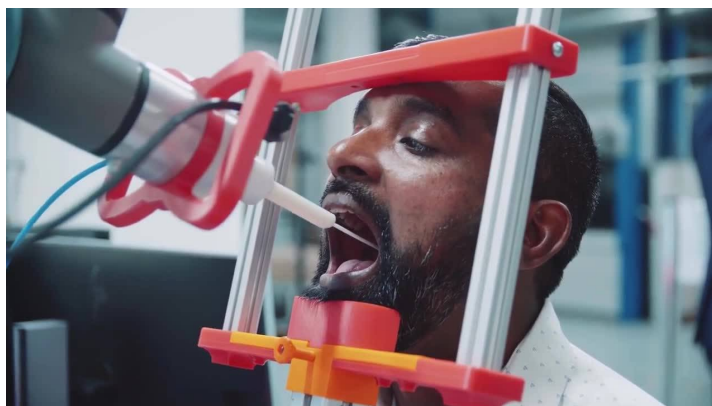
Figura 4.12: Realização de um teste COVID-19 com recurso a um robô colaborativo da Universal Robots [64]
