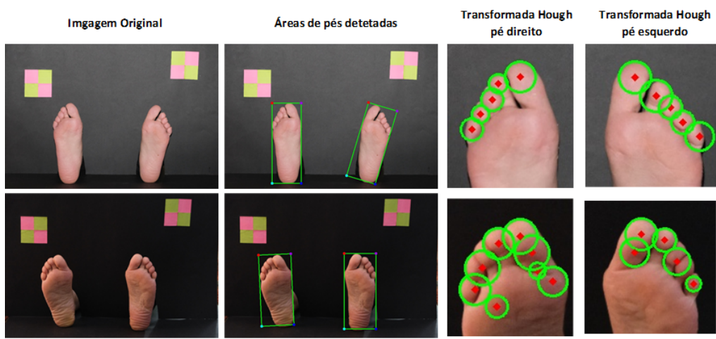
Figura 6.24: Amostra de resultados da aplicação do método de Hough para detetar dedos dos pés
