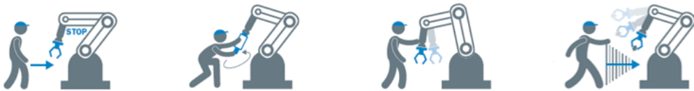
Figura 4.3: Modos de funcionamento colaborativos: paragem de segurança vigiada, guiamento manual, limitação de força e de potência e monitoramento da distância e da velocidade [47]
