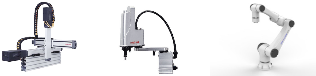
Figura 4.2: Exemplos de robôs: Cartesiano [40], SCARA [41] e Articulado [42]
