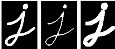
Figura 6.12: Comportamento das funções de erosão e dilatação da biblioteca OpenCV: à esquerda a imagem original, ao centro a imagem após uma erosão e à direita a imagem após uma dilatação [68]
