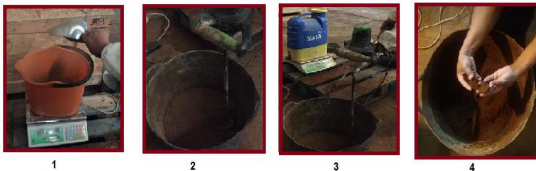
Figura 3.13 - Preparação da mistura para a prensagem. Nota: 1- Pesagem; 2- Homogeneização; 3- Adição de água a mistura; Verificação da humidade ótima por compressão da mistura com a mão
