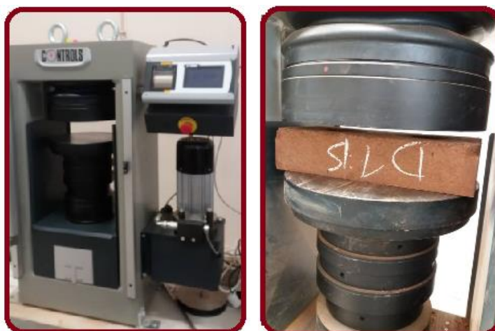
Figura 3.15 - Prensa de ensaios de compressão e o disco da prensa
