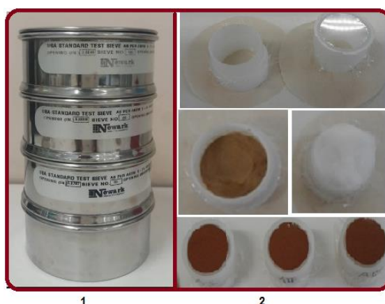
Figura 3.8 – Preparação da amostra para EFRX. Nota: 1 - Serie de peneiro; 2 - Provete
