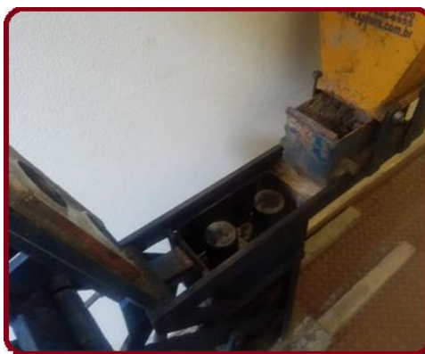
Figura 2.10 - Prensa utilizada em STP para a produção dos BTC
