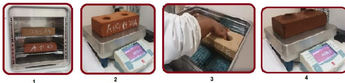
Figura 3.16 - Ensaio de absorção de água por imersão. Nota: 1 - Secagem das amostras; 2 - Pesagem a seco; 3 - Imersão das amostras no tanque; 4 - Pesagem húmida
