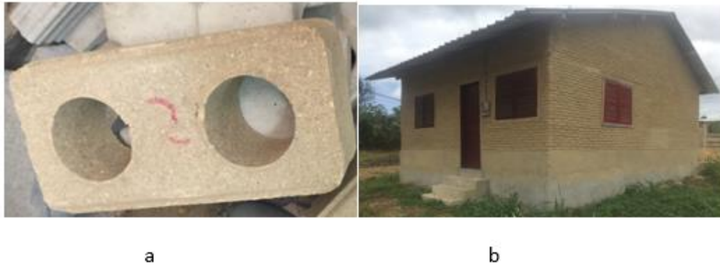
Figura 1.5 - Aplicação da terra como material de construção: a) BTC; b) construção em BTC.
