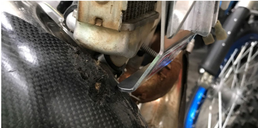
Figura 71 - Interferência entre Escape FMF e a Grelha radiador B&B Off-Road
