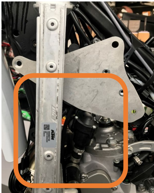
Figura 72 – Interferência entre o suporte interior e o sistema de refrigeração
