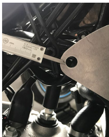
1 – Desalinhamento do ponto de fixação posterior
