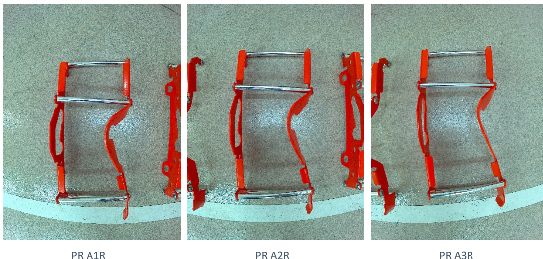
Figura 155 – PR Direita CROSSPRO 1, 2 e 3 - posterior ao impacto (desmontado da máquina de ensaio)
