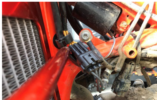
Figura 68 - Interferência do espaçador superior com o quadro do motociclo
