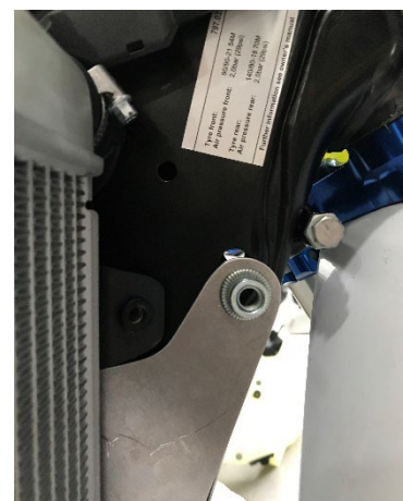
3 – Desalinhamento do ponto de fixação frontal
