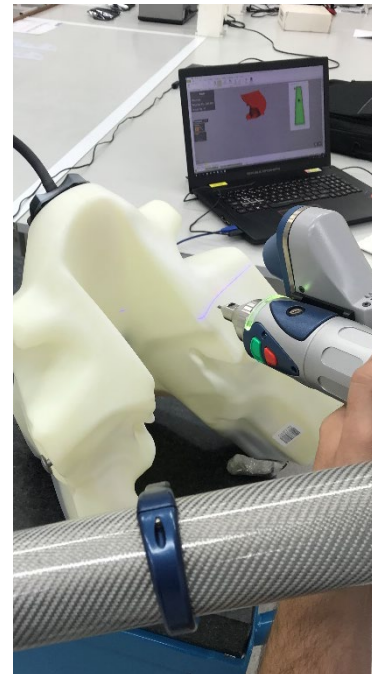
Figura 112 - Digitalização dos pontos do depósito de combustível
