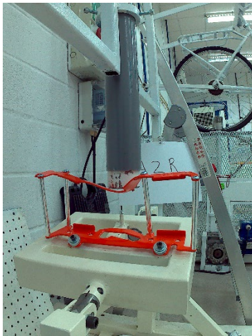
Figura 154 – PR Direita CROSSPRO - posterior ao impacto (montado da máquina de ensaio)
