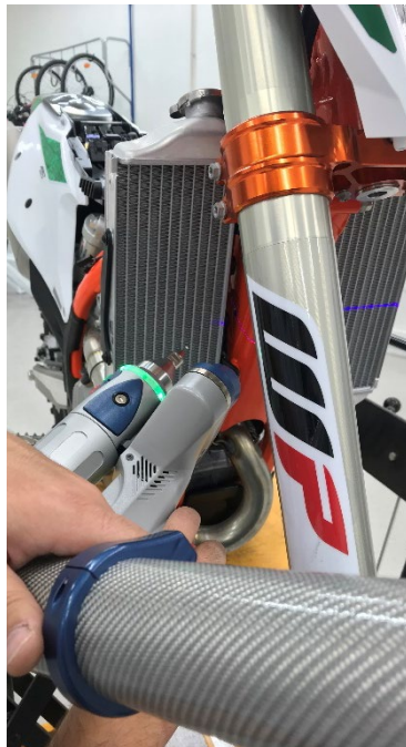
Figura 110 – Digitalização dos pontos de fixação posterior ao radiador
