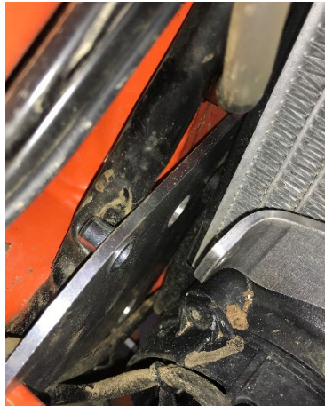
Figura 74 – Interferência entre suporte interior D e a cablagem do motociclo KTM EXC 450 2020
