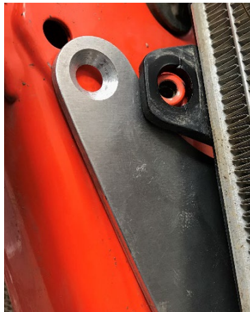
1 – Desalinhamento do ponto de fixação frontal
