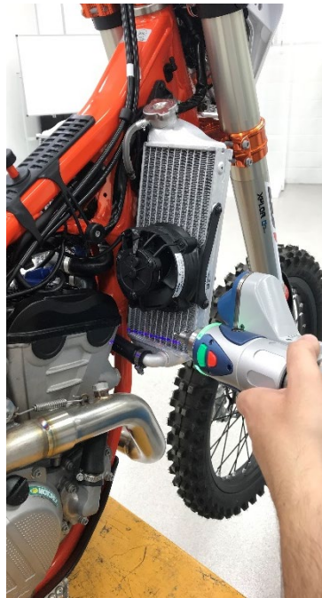
Figura 111 - Digitalização dos pontos de fixação anterior ao radiador
