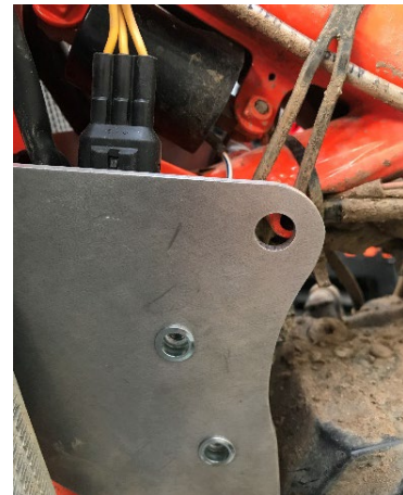
3 – Desalinhamento do ponto de fixação posterior
