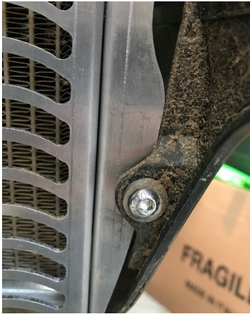
Figura 63 – Inferência entre a PR UNABIKER e peças plásticas KTM EXC 450 2020
