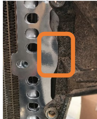
Figura 76 - Interferência entre tampa lateral de radiador e a Grelha radiador B&B OffRoad
