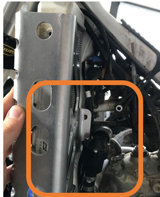
Figura 73 – Interferência entre o suporte exterior e o sistema de refrigeração
