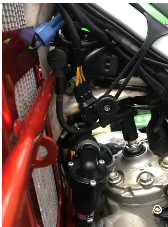
Figura 67 – Interferência do espaçador superior com o sistema de ignição
