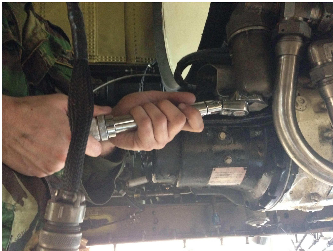
Figura 19 - Mecânico a executar ação de manutenção com chave de torque
