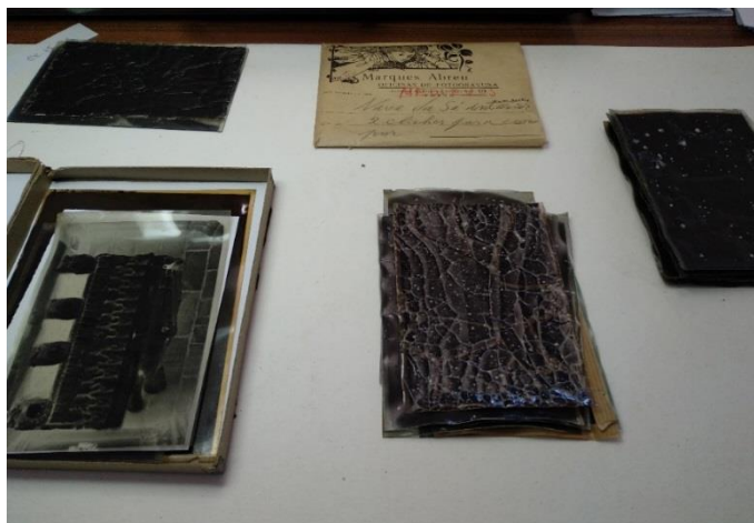
Figura 10 – Espécies (negativos de película 10x15cm) em estado de deterioração. (Fonte: Foto tirada por Marta Neto)
