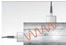
Figura 5.6.: Modo de aplicação das sondas PROCEQ (2015)
