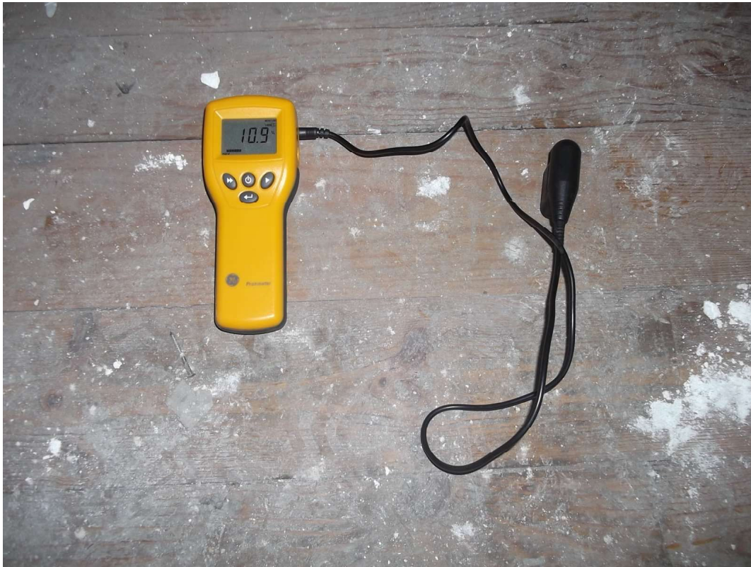
Figura 5.18.: Medição do teor em água
