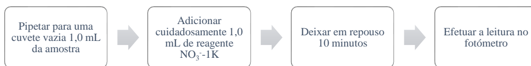
Figura A.3. Procedimento para a determinação de nitratos na gama de 0,5-25,0 mg/L de \text{NO}_3^- -N.
