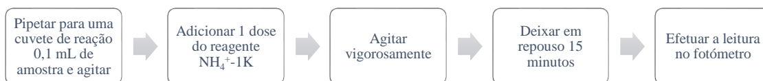
Figura A.5. Procedimento para a determinação do azoto amoniacal na gama de 4,0-80,0 mg/L \text{NH}_4^+ -N.
