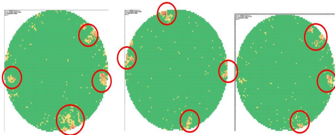
Figura 57 - Resultado das falhas após operações manuais.
