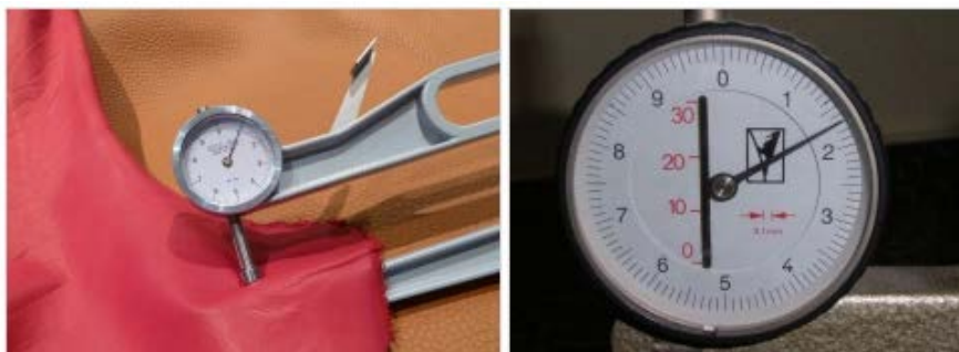
Figura 10 – Equipamento utilizado para medir a espessura do couro [14]
