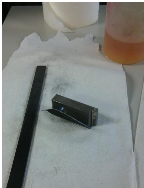
Figura 25 - Processo de lixagem e limpeza dos substratos
