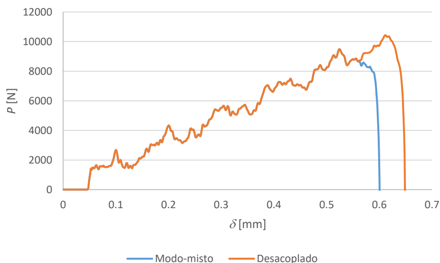
Figura 80 - Curvas P - \delta correspondentes a modo-misto e desacoplado e com adesivo AV138 e L_0=25 mm
