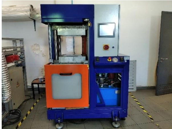
Figura 23 - Prensa de pratos quentes utilizada para prensar as placas
