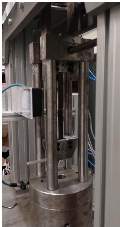
Figura 31 - Provete colocado na máquina de drop weight
