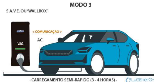
Figura 7 Modo 3 de carregamento [2].
