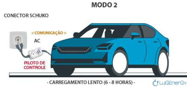
Figura 6 Modo 2 de carregamento [2].
