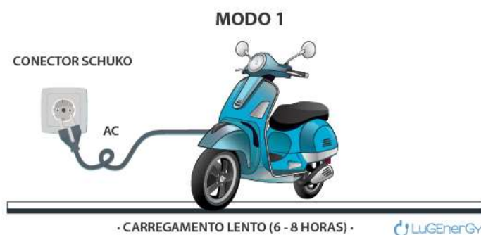
Figura 5 Modo 1 de carregamento [2].
