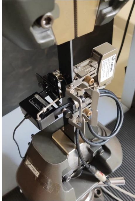
Figura 26 - Ensaio de tração para identificação das propriedades elásticas da placa compósita.
