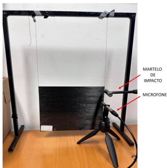
Figura 23 - Medição das frequências naturais da placa laminada com o microfone
