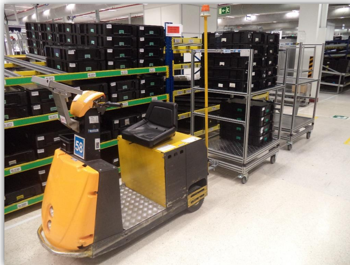
Figura 24 - Comboio Logístico real, com duas carruagens atreladas.
