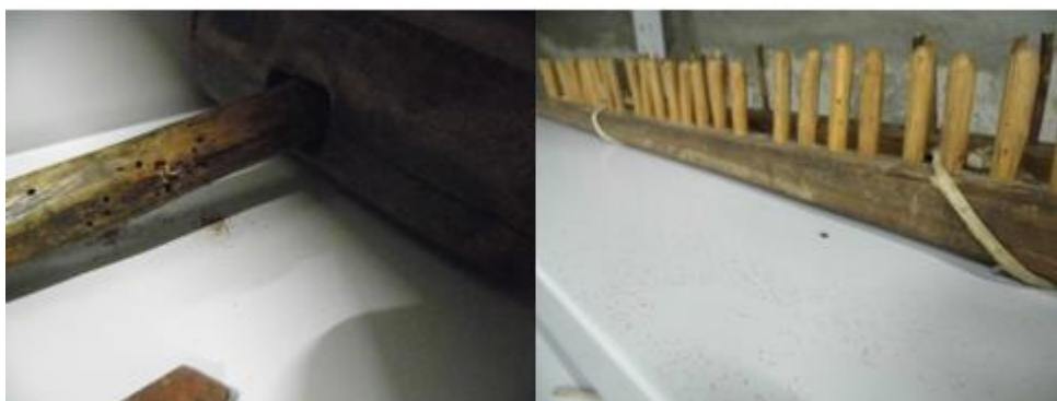
Figura 18 - Observação dos orifícios denominados de galerias em objetos de madeira (Fonte: Imagem da autora)
