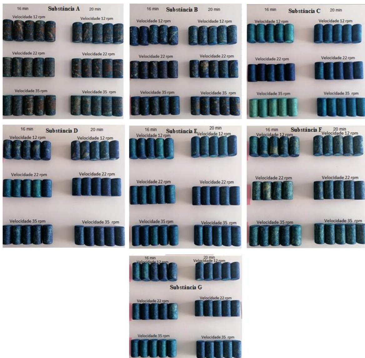
Figura G.3 - Coloração com a solução de azul metileno nas rolhas SPI.
