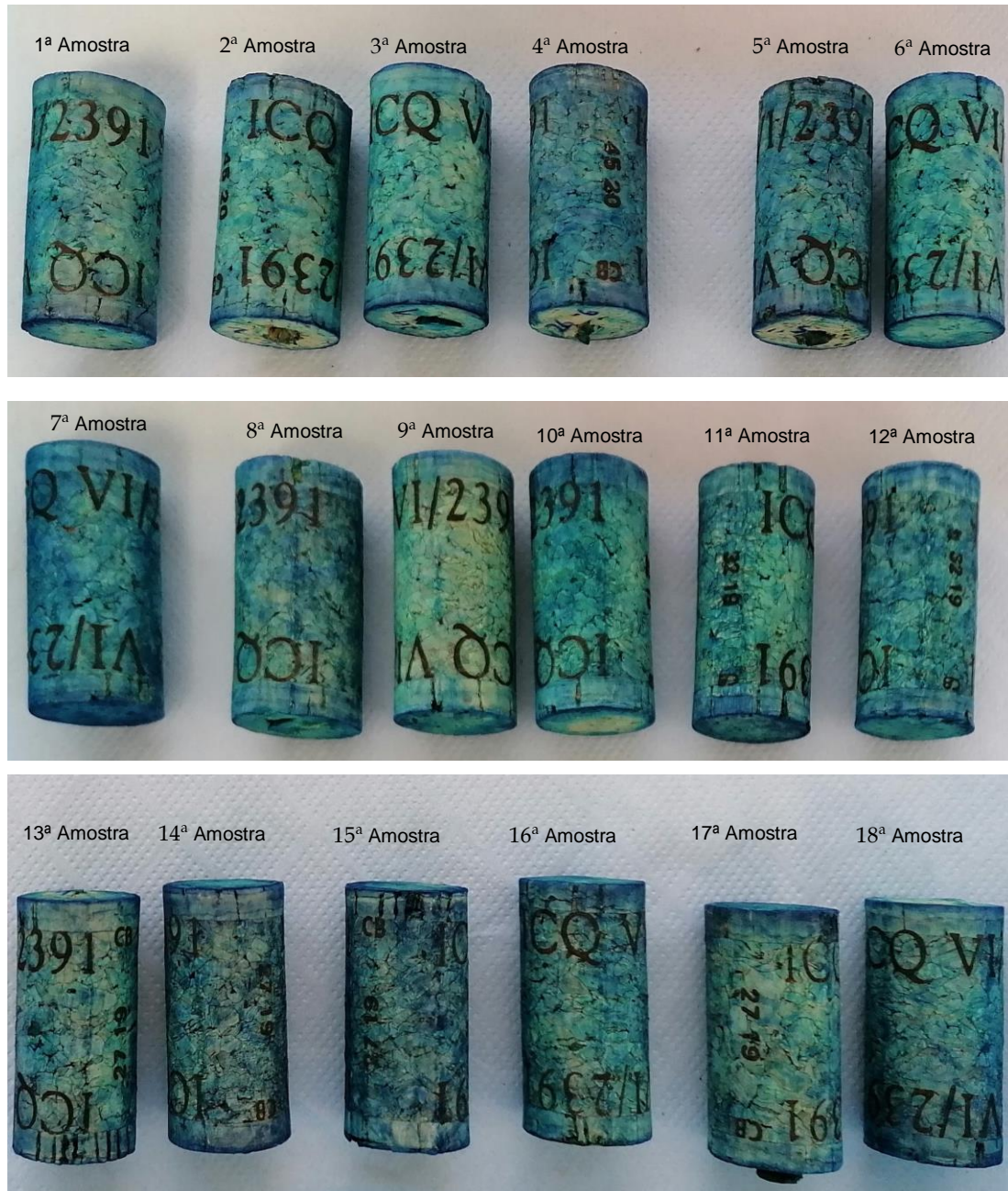
Figura E.2.1 - Coloração da rolha 1+1 tratada, com solução azul metileno.
