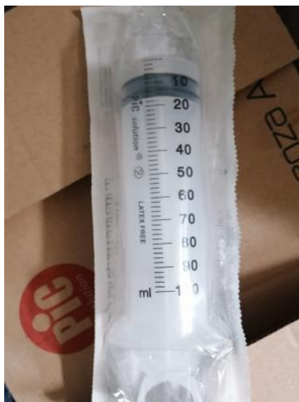
Figura 3.3 - Seringa utilizada para medição e colocação da substância de tratamento de superfície das rolhas de cortiça. Capacidade de 100 mL.
