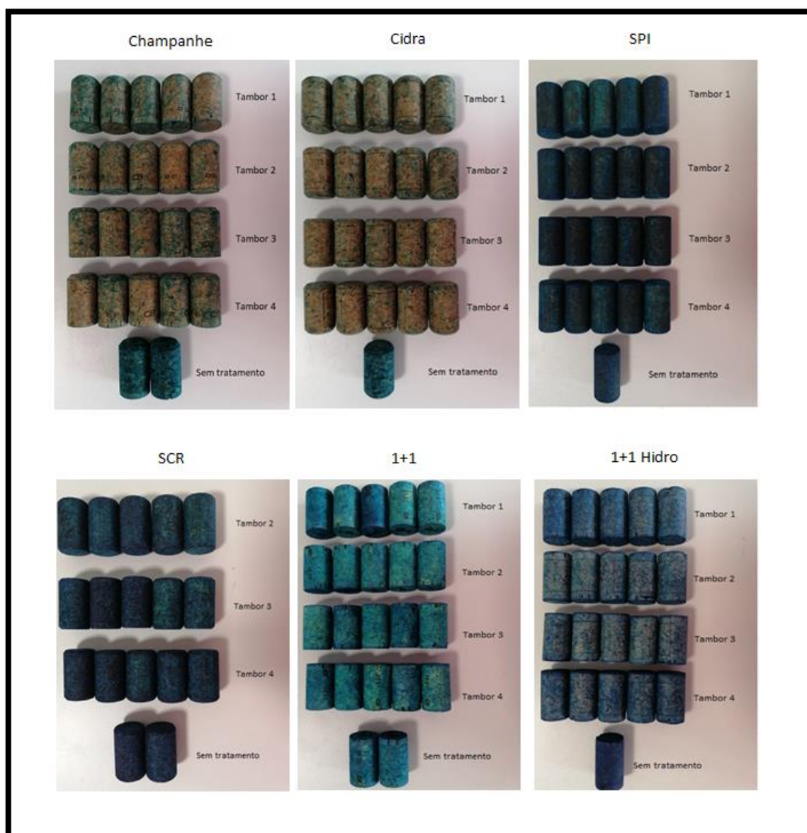
Figura 5.8 - Análise da distribuição da substância de tratamento, no respectivo tipo de rolha, com o método qualitativo de solução de azul metileno.
