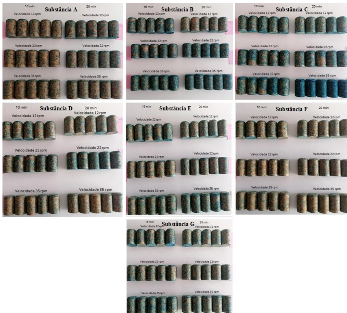
Figura G.2 - Coloração com a solução de azul metileno nas rolhas Champanhe.
