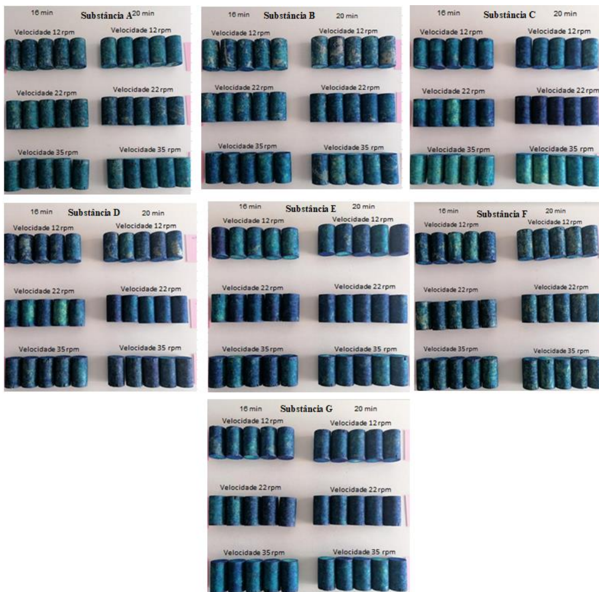
Figura G.5 - Coloração com a solução de azul metileno nas rolhas 1+1.
