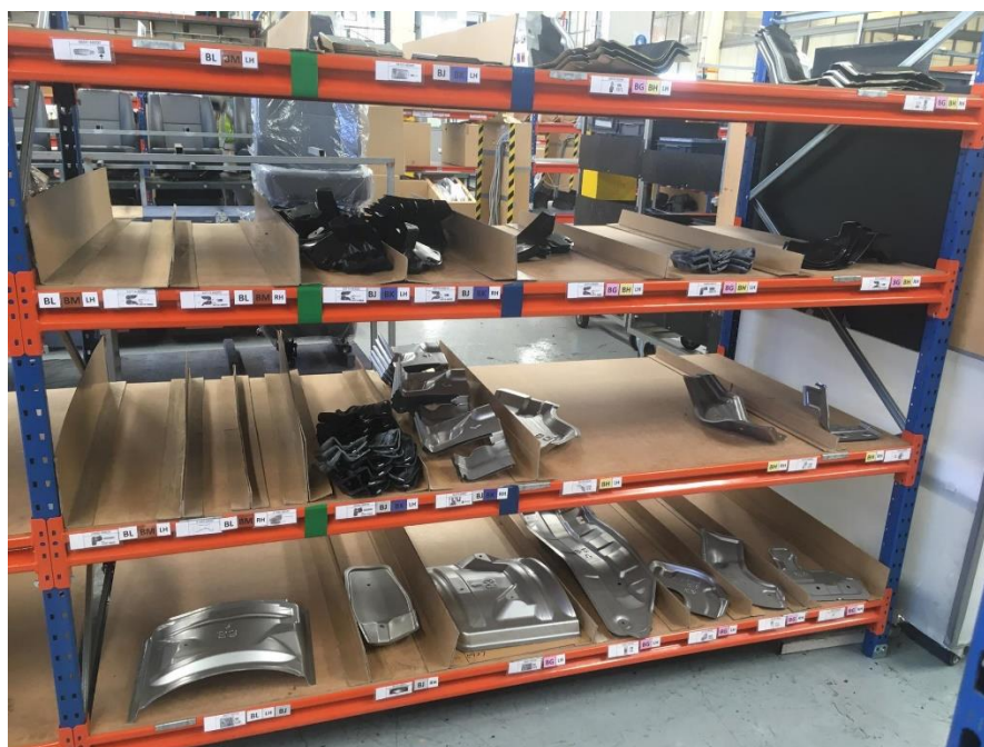
Figura 28 - Método utilizado nas racks do posto OH para a identificação do material específico de cada modelo (Fonte: O Autor)
