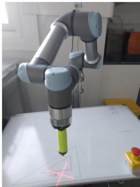
Figura 1 – Robô colaborativo UR5 com manipulador dotado de apontador laser
