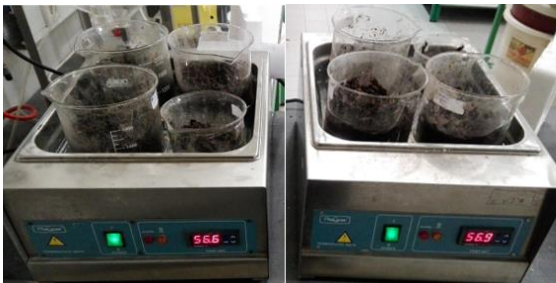
Figura 3.14 - Simulação real do processo de biodegradação acelerada no Laboratório de Tecnologia
