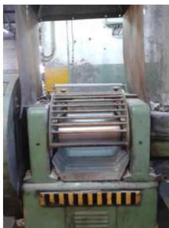
Figura 3.2 – Misturador de rolos aberto à escala de instalação piloto
