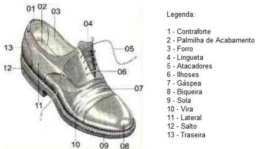
Figura 2.1 - Componentes de um sapato 7
