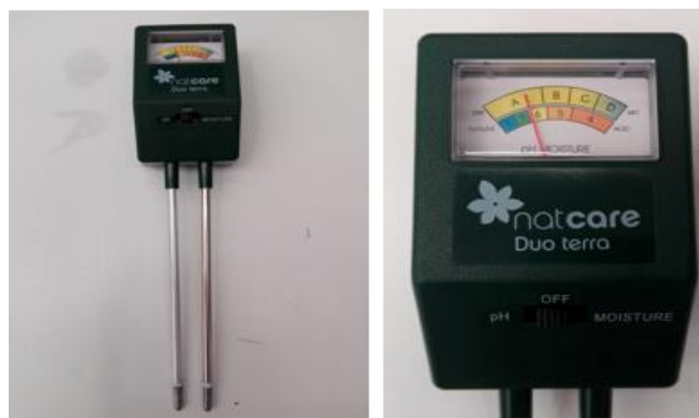
Figura 3.15 - Medidor de pH e humidade para solos, modelo Natcare
