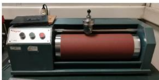
Figura 3.12 - Abrasímetro de tambor rotativo, modelo Pegosal
