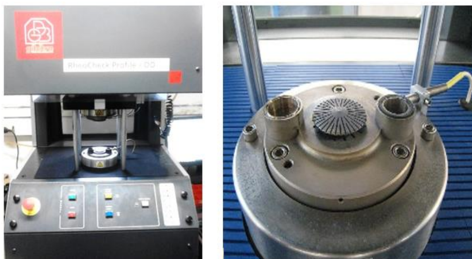
Figura 3.5 - Reómetro de disco oscilante de câmara fixa(ODR), modelo RCC 2015056 da Gibitre Instruments 106
