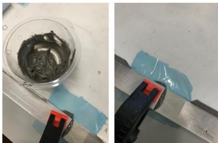
Figura 39 – Exemplo do processo de fixação adotado durante o processo de cura (exemplo das juntas AV 138M/HV 998).
