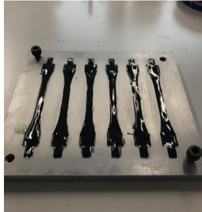
Figura 33- Preenchimento do molde com o adesivo
