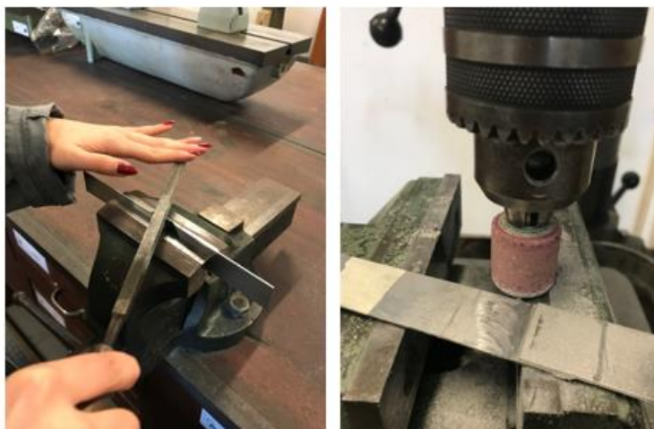
Figura 40 - Remoção do excesso de adesivo.
