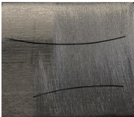
Figura 38 - Colocação dos fios de nylon para definição da espessura da camada adesiva.
