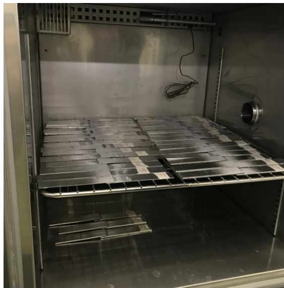
Figura 44 - Colocação das chapas na câmara térmica.
