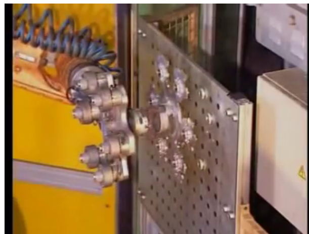
Figura 4.9: Zona de inspeção visual da peça recém fundida [47]
