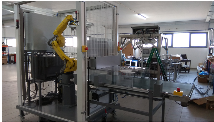
Figura 5.5: Localização das botoneiras de emergência
