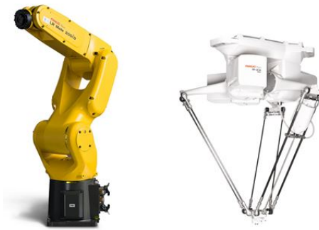
Figura 2.6: Da esquerda para a direita: manipulador série Fanuc Mate 200iD [15], manipulador paralelo/delta Fanuc M-2iA/3SL [16]
