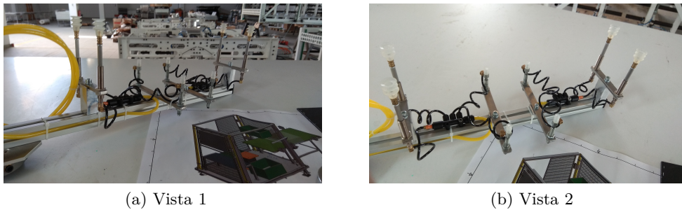
Figura 5.11: Garra de manipulação de peças composta por ventosas
