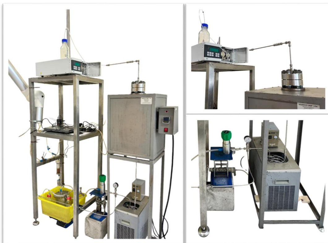
Figura 3.9. Montagem da instalação experimental de gasificação supercrítica.
