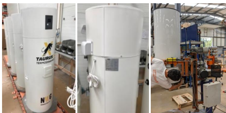
Figura 32 - Aplicação de autocolantes, etiquetagem e processo de limpeza
