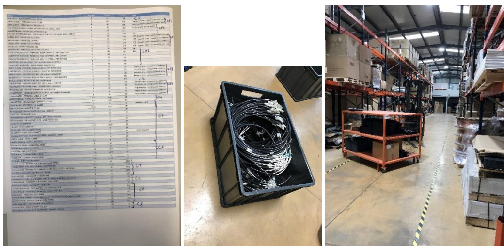
Figura 56 – Documento de agrupamento das MP's por caixas de armazenagem/grupos de tarefas, exemplo de armazenagem em caixa e rack completamente abastecida
