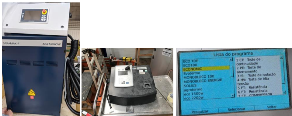
Figura 31 - Máquina de Vácuo e Carga de Gás e máquina de Teste Elétrico
