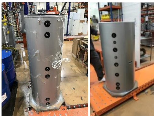
Figura 28 - Termoacumulador por detalhar
