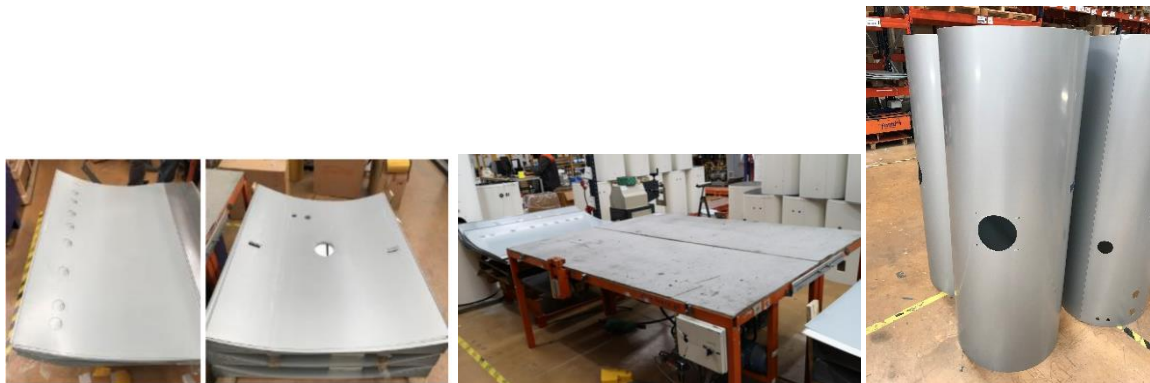
Figura 25 - Armazenamento das chapas, mesa de clinchagem e stock intermédio
