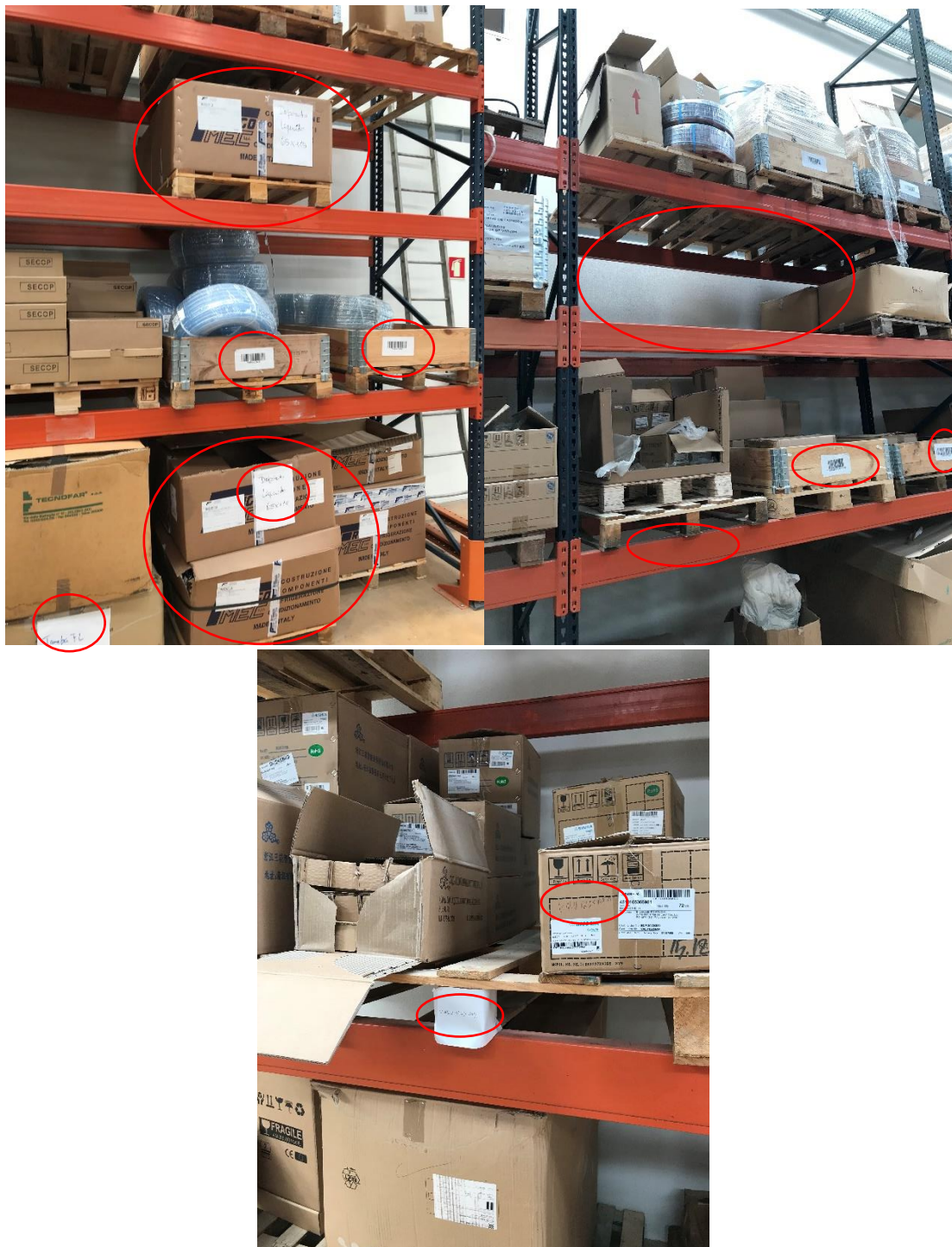
Figura 114 – Problemas identificados na zona de armazenagem antes da ação 5S
