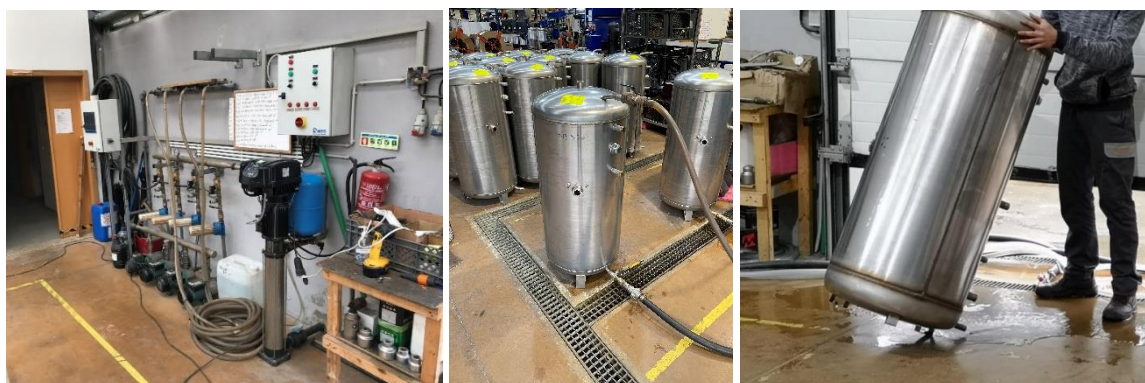
Figura 23 - Máquina de Teste Hidráulico, teste de cuba e seu esvaziamento
