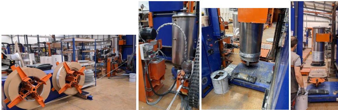
Figura 24 - Bobines para Enrolamento, enrolamento do condensador e movimentação final
