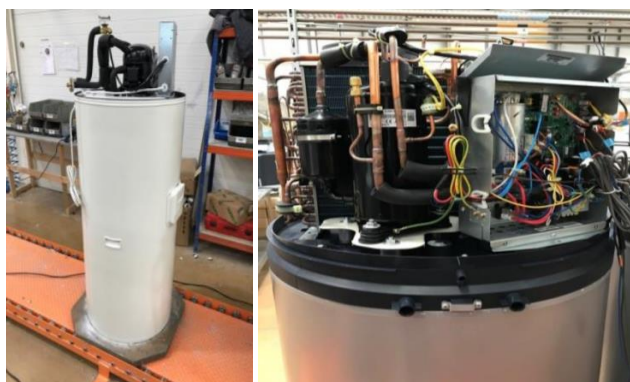
Figura 29 - Processo de montagem do GT ao termoacumulador para formação do sistema
