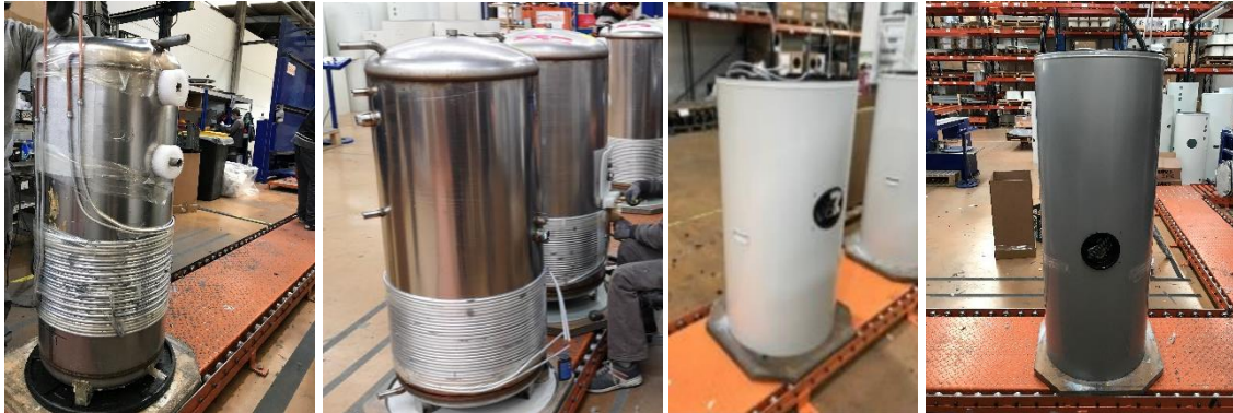
Figura 26 - Tratamento do condensador, aplicação de espumas e encamisar
