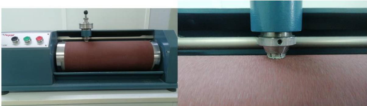
Figura 2.14 Abrasímetro usado no ensaio de resistência à abrasão
