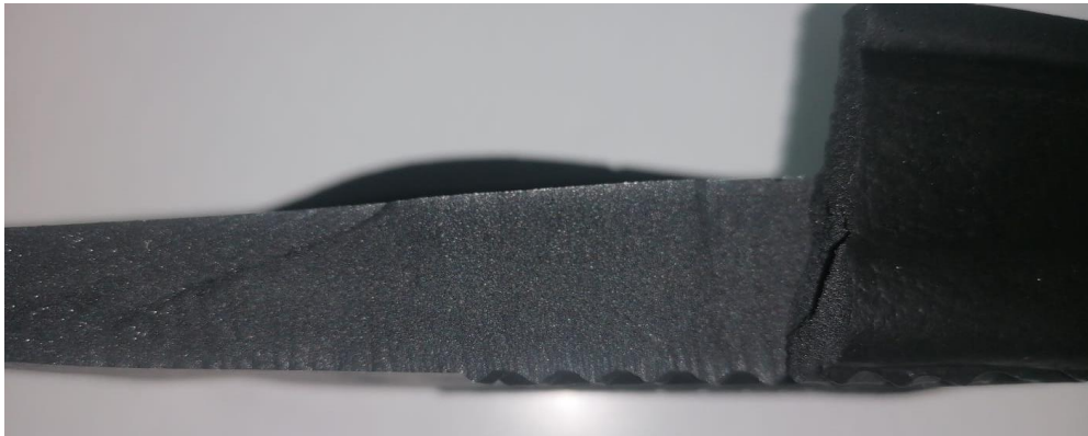
Figura 2.10 Corte longitudinal de uma sola em PU microcelular
