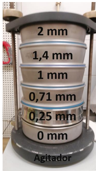
Figura 3.3 Torre dos diferentes peneiros usados na separação
